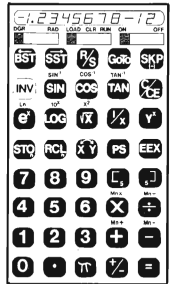
Fig. 5. - Voici enfin le calculateur le plus complet, programmable, et disposant de 10 mémoires adressables (et 5 niveaux de parenthèses).
