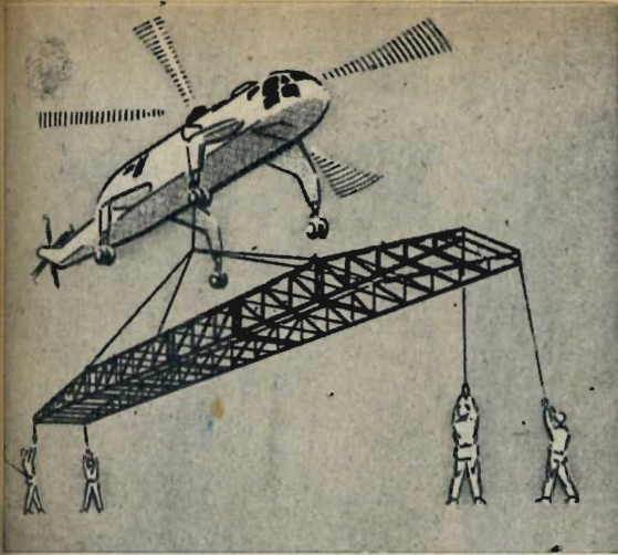
Ecco il disegno dell'elicottero inglese, Westminister, ora in costruzione. Assomiglia ad un mostruoso insetto dalle lunghe gambe. È mosso da 2 turbine a gas Napier da 3650 CV. Porterà 50 persone.
