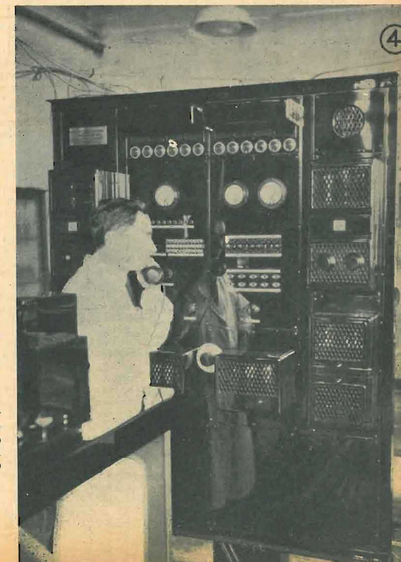
Fig. 4. - Pannello di comando del crittografo Belin con gli amplificatori di trasmissione (a sinistra) e di ricezione (a destra). Nel mezzo: Apparecchi di controllo e di misura. In alto: le spie luminose di sicurezza.
