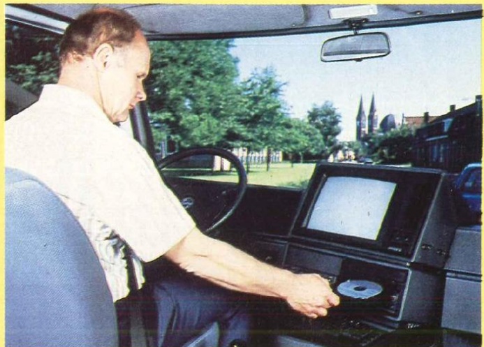
C) Le système CARIN est activé en mettant en place un «Compact-Disc» ayant en mémoire la cartographie de la zone traversée.
