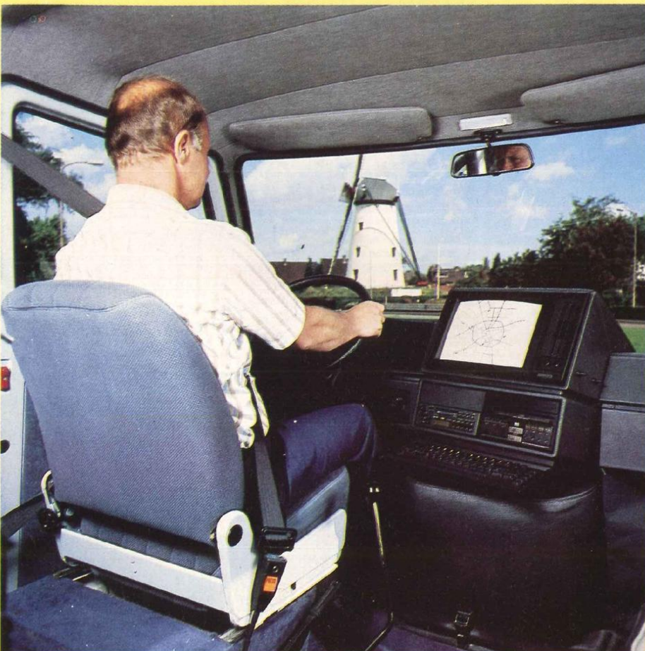
D) La console de visualisation est utilisée pour l'affichage du réseau routier et la localisation du véhicule.
