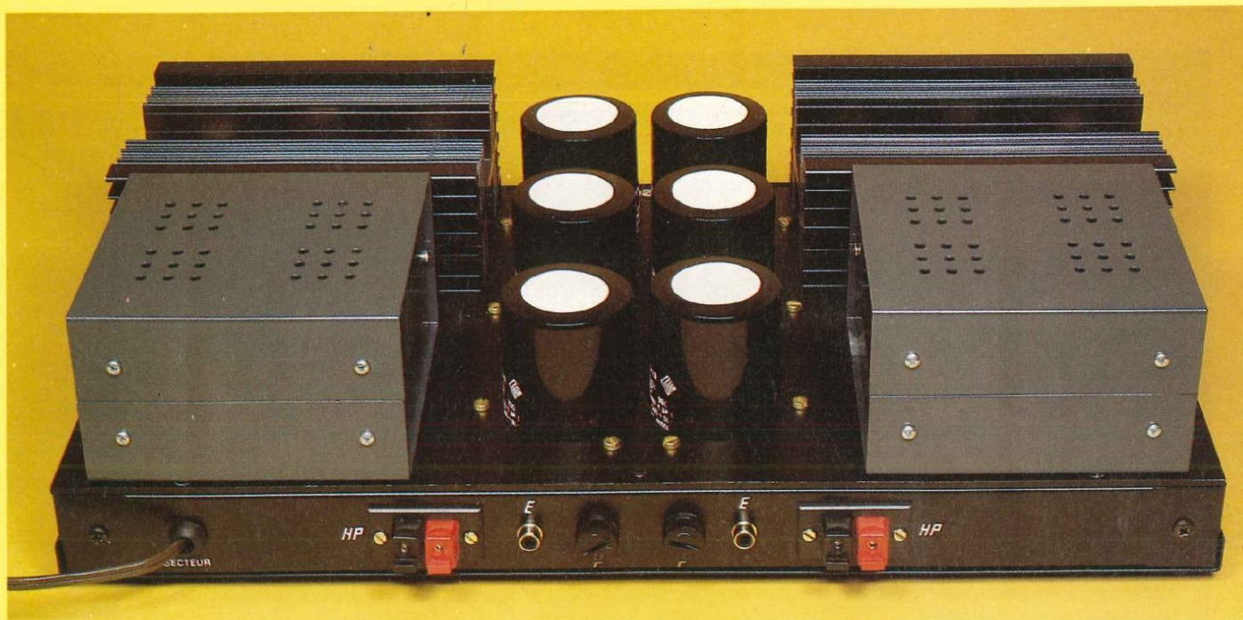
Vue arrière de l'appareil. Le raccordement de l'amplificateur aux enceintes est effectué au moyen de borniers « pressions ». Les transformateurs sont enfermés dans des boîtiers métalliques ESM. La modulation est appliquée à des prises CINCH.
