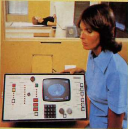
Console de contrôle d'un tomodensimètre.
