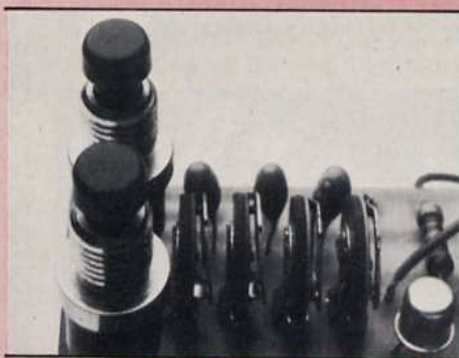
Vue de détail des boutons poussoirs et des trois condensateurs qui permettent de changer d'octave.
