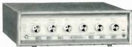
Il nuovo amplificatore stereo Sherwood S-5500 IV presenta un pannello frontale con una presa stereo per cuffia ed un commutatore per disinserire l'altoparlante. La potenza musicale è di 80 W. La sensibilità fono è eccezionale: 1,2 mV. La rumorosità e il ronzio misurano 72 dB sotto la potenza nominale. L'apparecchio ha 9 tubi elettronici e 4 rettificatori al silicio.
