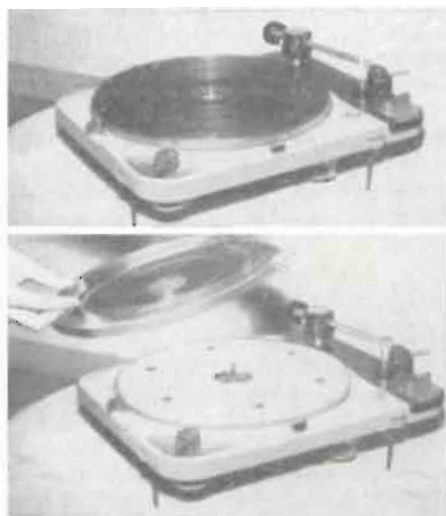
Fig. 1 - Una delle principali caratteristiche della piastra giradischi TD124 è quella di essere composta da un piatto diviso in due parti. Il primo, assai leggero e di alluminio, ed è quello su cui poggia il disco da riprodurre. Esso è inserito sul secondo, alquanto pesante, costituito di ghisa, cui può essere reso solidale mediante un dispositivo di frizione assai semplice.
