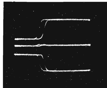
Fig. 7 - Caratteristiche di modulazione per un segnale positivo, nullo e negativo (spazzolamento sinusoidale).
