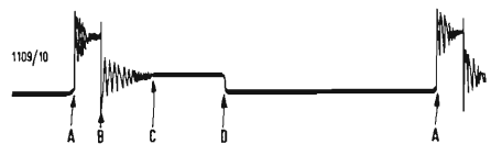
Fig. 7 - Diagramma di accensione corretta di un cilindro, l'immagine è rovesciata dall'alto in basso se la batteria ha il meno collegato a massa.
