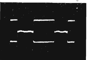
Fig. 5 - Aspetto dell'onda modulata per un segnale di 100 mV. Vi sono due fotogrammi successivi corrispondenti a due polarità.
