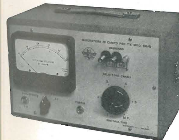
MISURATORE DI CAMPO Mod. 105/S Sensibilità da 5 μV 50.000 μV
