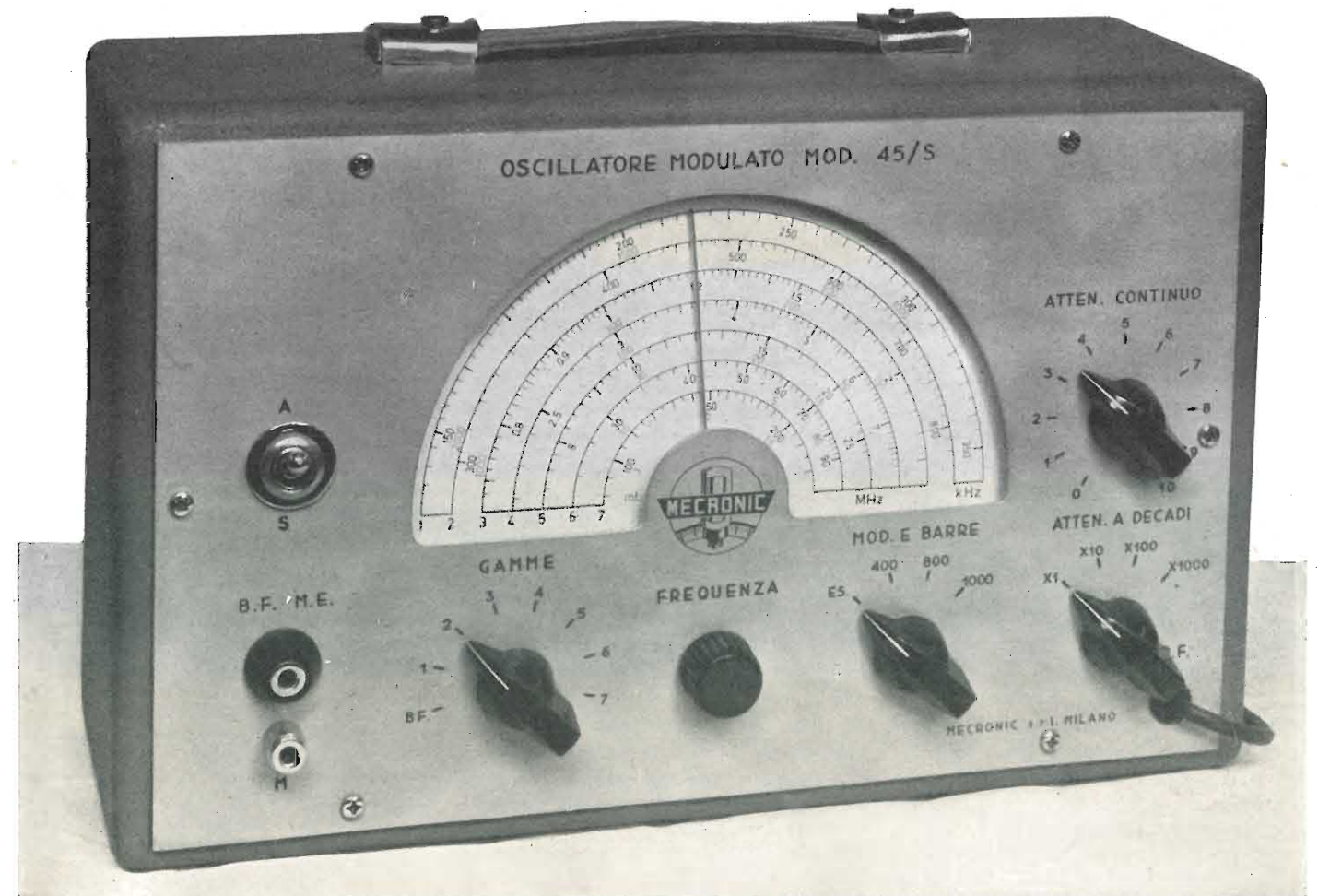
Fig. 2 - L'oscillatore modulato Mod. 45/S, costruito dalla Mecronic. E' visibilissima la disposizione dei comandi sul pannello frontale.
