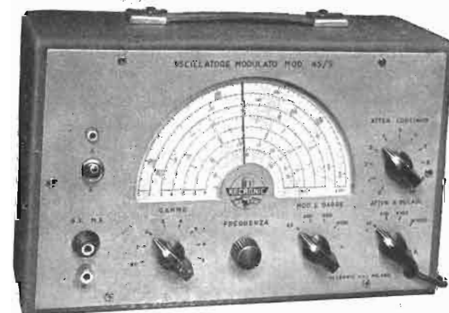
OSCILLATORE MODULATO Mod. 45/S - Per Radio FM e TV Campo di frequenza: 150 kHz ÷ 225 in 7 gamme. Modulazione: interna a 400-800-1.000 Hz - Barre orizzontali - Morsetti per modul. esterna e Barre verticali - Uscita BF - Doppia schermatura - 2 attenuatori.
