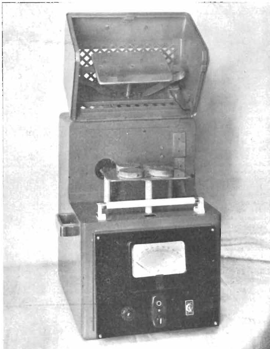
La foto illustra un piccolo preriscaldatore ad A. F. per materiali termoindurenti. Capacità di trattamento: 200 grammi in 2 minuti. Si noti sulla piastra il materiale (urea) in forme di pastiglie.
