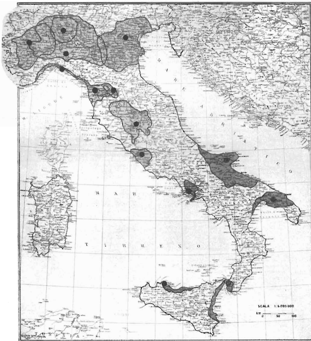
La rete televisiva italiana della R.A.I. Le aree più chiare corrispondono ai trasmettitori della 1ª fase; quelle più scure ai trasmettitori della 2ª fase. Tutti i trasmettitori saranno intercollegati mediante la nuova rete statale di cavi coassiali. Tutti i trasmettitori hanno la potenza di 5 kW cresta, ad eccezione di quello di M. Penice (a Sud di Milano) che è di 10 kW cresta.
