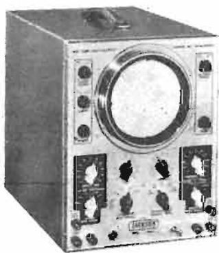
Oscilloscopio Mod. CRO - 2 tubo 5" - 4,5 MC
