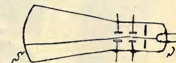
gio. Basta modificare la tensione delle placche per far descrivere al raggio una linea retta sullo schermo S. È chiaro che ponendo di seguito due di questi condensatori è possibile deviare il raggio catodico secondo due direzioni perpendicolari e quindi combinando opportunamente le tensioni si può spostare la macchia luminescente sullo schermo S in un punto voluto. Ai condensatori possono sostituirsi dei campi magnetici prodotti da bobine percorse da corrente.
