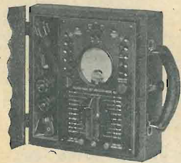
Analizzatore di Radioriceventi Mod. 606 per c. c. e c. a.
