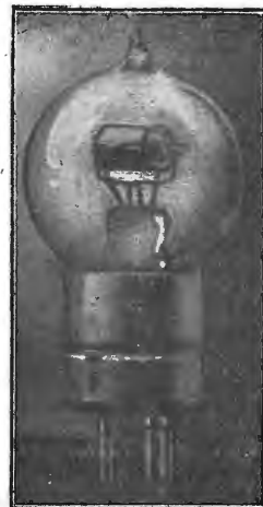
Valvola tipo D V 1, per ricezione, a coefficiente di amplificazione molto alto.
