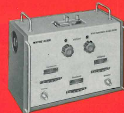
Fig. 8 - Ponte per misure d'ammettanza VHF
