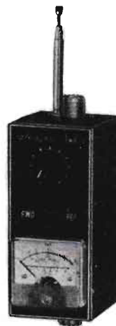
Fig. 3 - Modello, di tipo commerciale, di strumento misuratore di campo. Viene usato anche dagli antennisti per valutare l'intensità del campo elettromagnetico nel punto in cui si deve installare una antenna.
