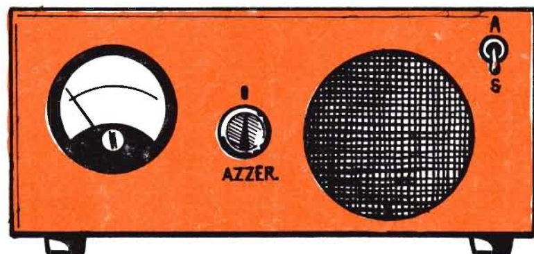
Fig. 4 - Esempio di pannello frontale di un contenitore metallico nel quale conviene inserire il circuito del misuratore di campo per radiocomando. Gli elementi visibili sono: il microamperometro, il potenziometro di azzeramento R11, l'altoparlante e l'interruttore del circuito di alimentazione.
