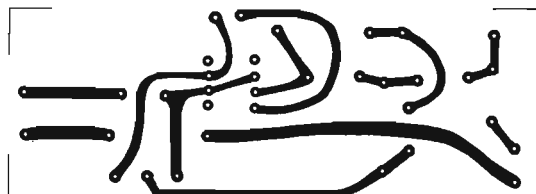
Fig. 4 - Disegno del circuito stampato in grandezza naturale necessario per la costruzione del dispositivo di filtro antironzio.
