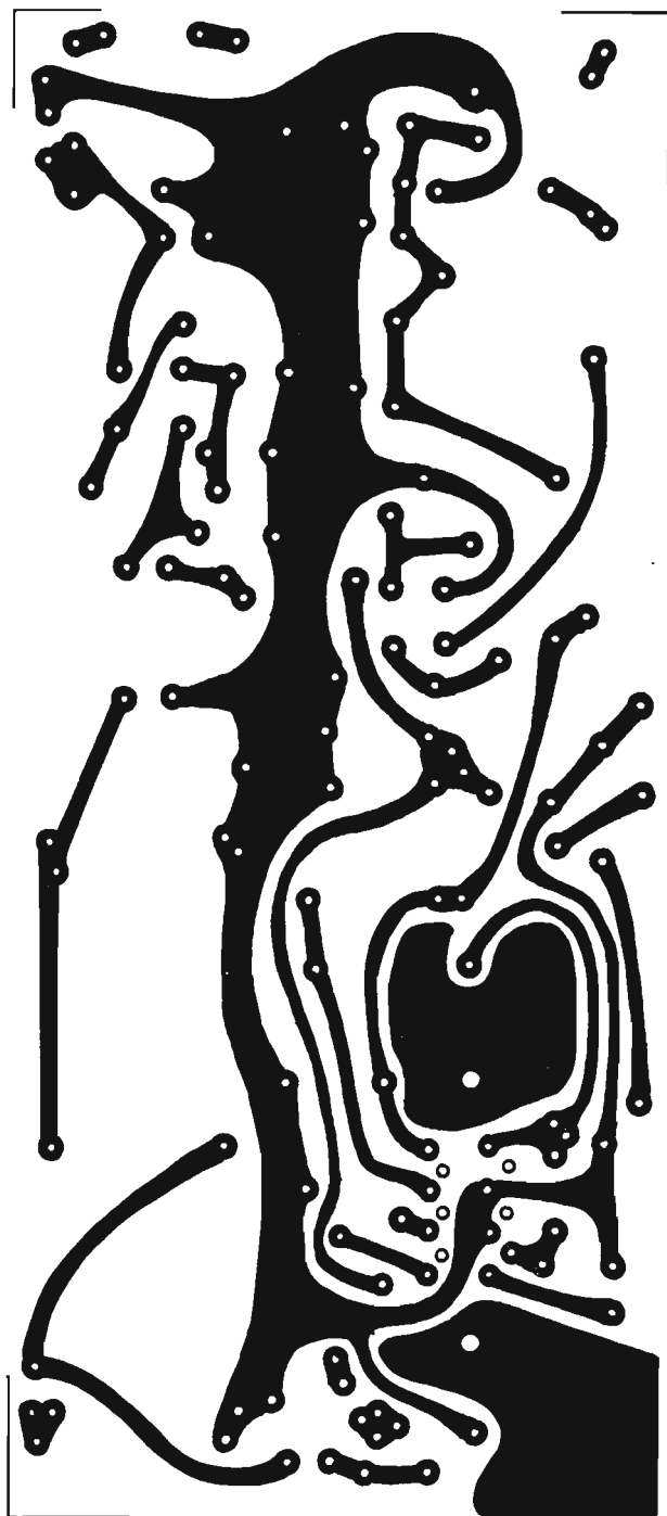
Fig. 5 - Disegno al vero del circuito stampato necessario per la composizione del progetto del ricevitore a conversione diretta.
