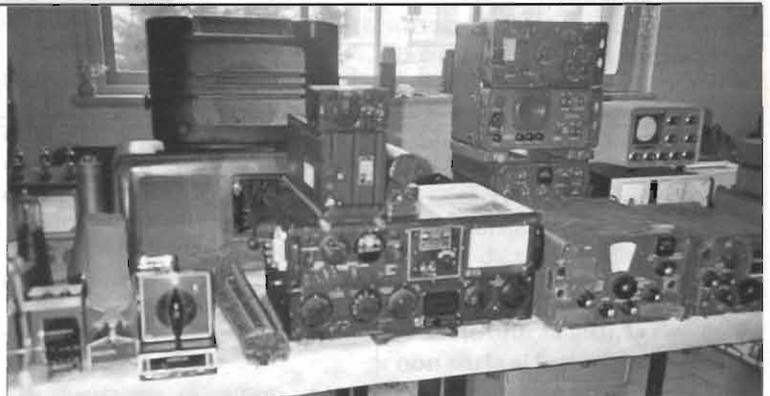
Foto 3 - Un bel banco di Surplus in primo piano un bell'ART-13 Tx e, in secondo piano, un Rx AN-GRC5.
