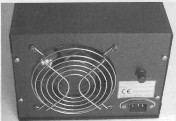
figura 6 - Pannello sul retro della scatola. La grossa ventola è protetta dalla retina anti-intrusione, mentre tra il fusibile e la spina di rete c'è l'etichetta con i dati dell'alimentazione richiesta.
