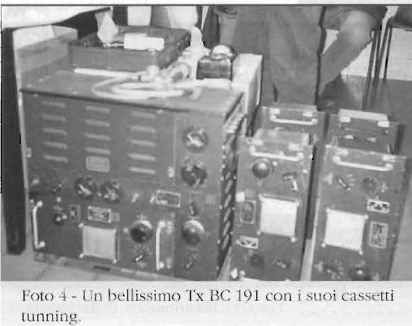
Foto 4 - Un bellissimo Tx BC 191 con i suoi cassette tuning.
