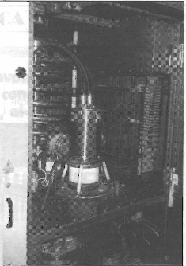
Una valvola utilizzata dai trasmettitori da 100kW di Prato Smeraldo.
