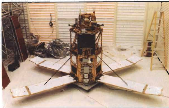
figura 1 - SeaStar completamente assemblato prima di affrontare i test nel maggio '95. Provided by the SeaWiFS Project, NASA/Goddard Space Flight Center.
