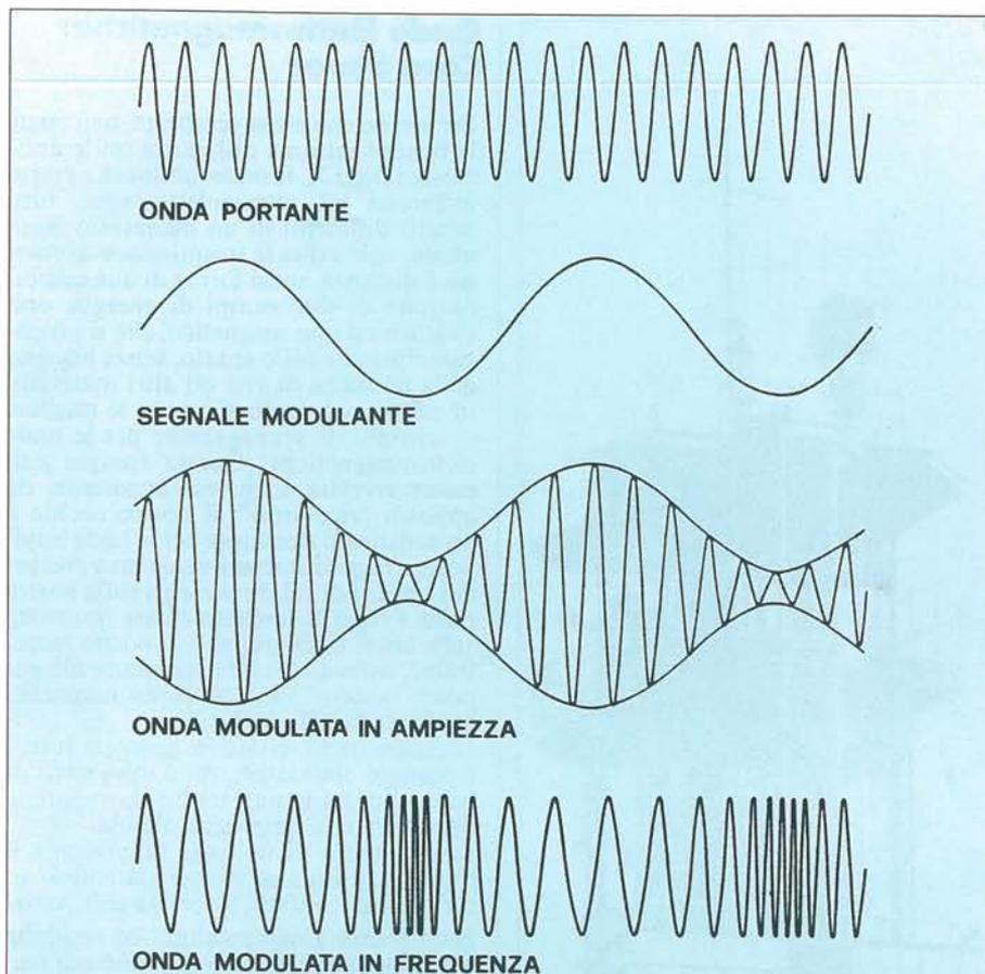
Figura 1. Rappresentazione schematica del fenomeno della modulazione di un'onda radio. Il segnale modulante agisce sull'onda portante alterandone o l'ampiezza (modulazione d'ampiezza) o la frequenza (modulazione di frequenza).
