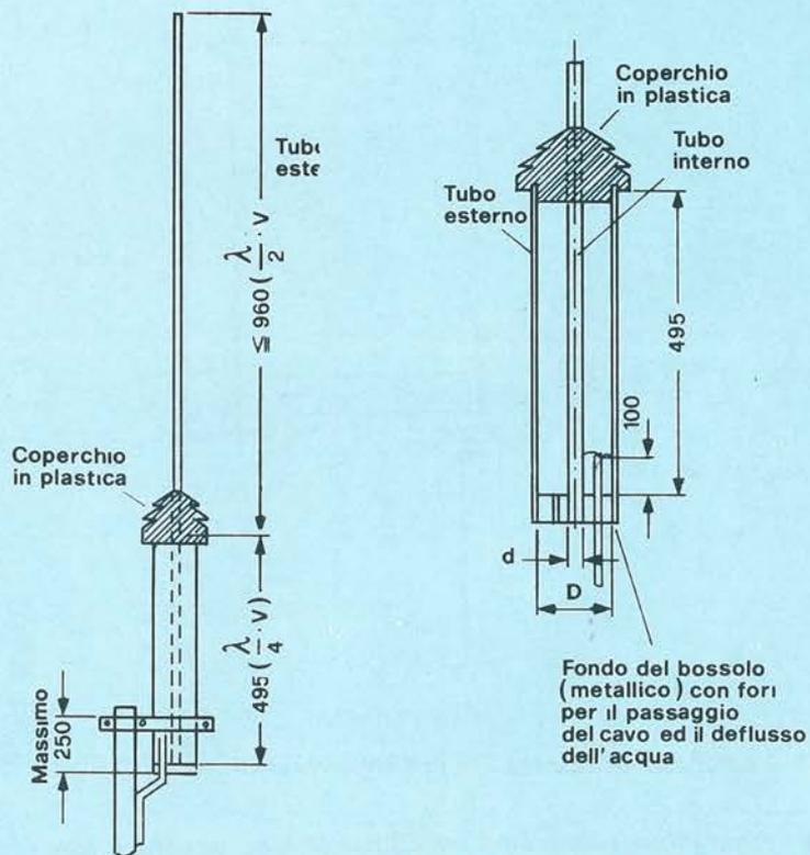
Figura 23. Antenna J per la banda dei 2 m.
