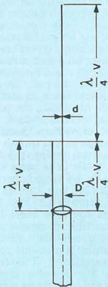
Figura 22. L'antenna J può essere alimentata anche tramite un cavo coassiale.
