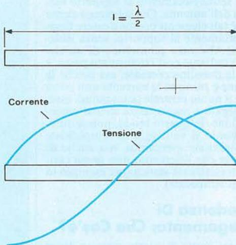
Figura 3. Interrompendo al centro questa antenna  $\lambda/2$ , al punto di separazione potrà essere collegato un cavo a bassa impedenza.
