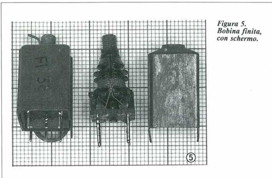
Figura 5. Bobina finita, con schermo.
