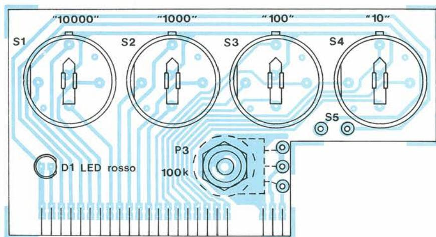
Figura 7a. Disposizione dei componenti sul circuito stampato.
