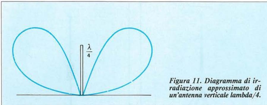
**Figura 11. Diagramma di irradiazione approssimato di un'antenna verticale  $\lambda/4$ .**
