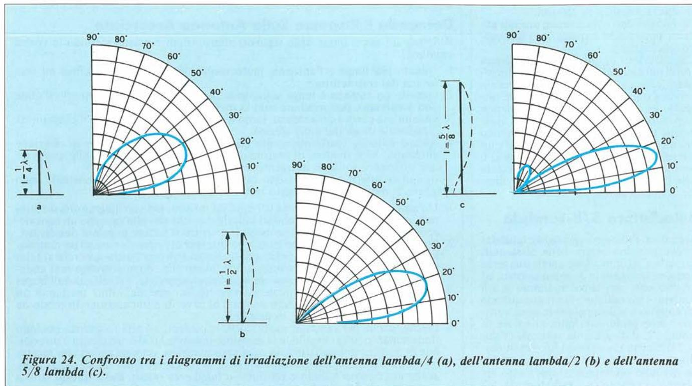
Figura 24. Confronto tra i diagrammi di irradiazione dell'antenna  $\lambda/4$  (a), dell'antenna  $\lambda/2$  (b) e dell'antenna  $5/8 \lambda$  (c).
