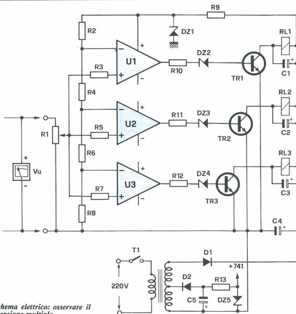
Figura 1. Schema elettrico: osservare il partitore di tensione multiplo.
