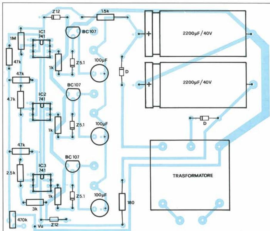
Figura 3. Disposizione dei componenti sul circuito stampato.
