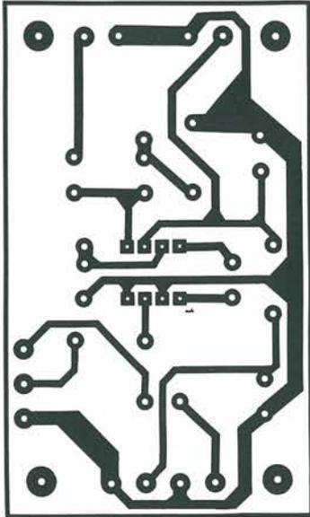
Figura 3. La basetta a circuito stampato. Scala 1:1.
