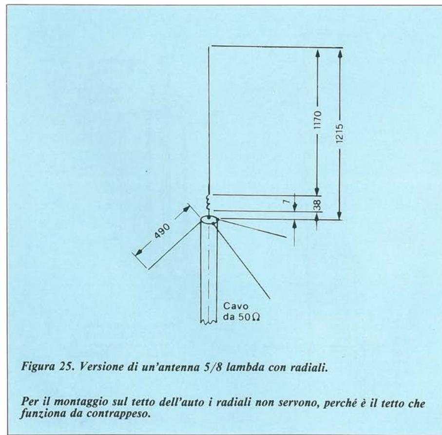
Figura 25. Versione di un'antenna  $5/8 \lambda$  con radiali.
