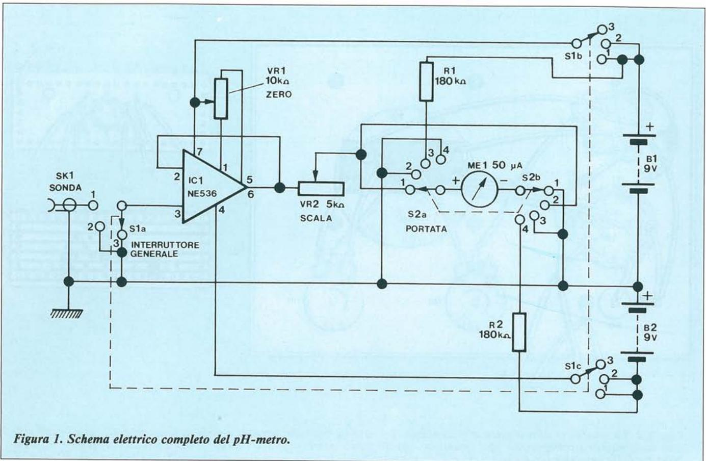
Figura 1. Schema elettrico completo del pHmetro.
