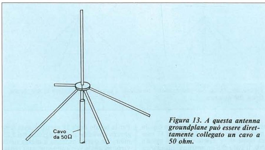
**Figura 13. A questa antenna groundplane può essere direttamente collegato un cavo a 50 ohm.**
