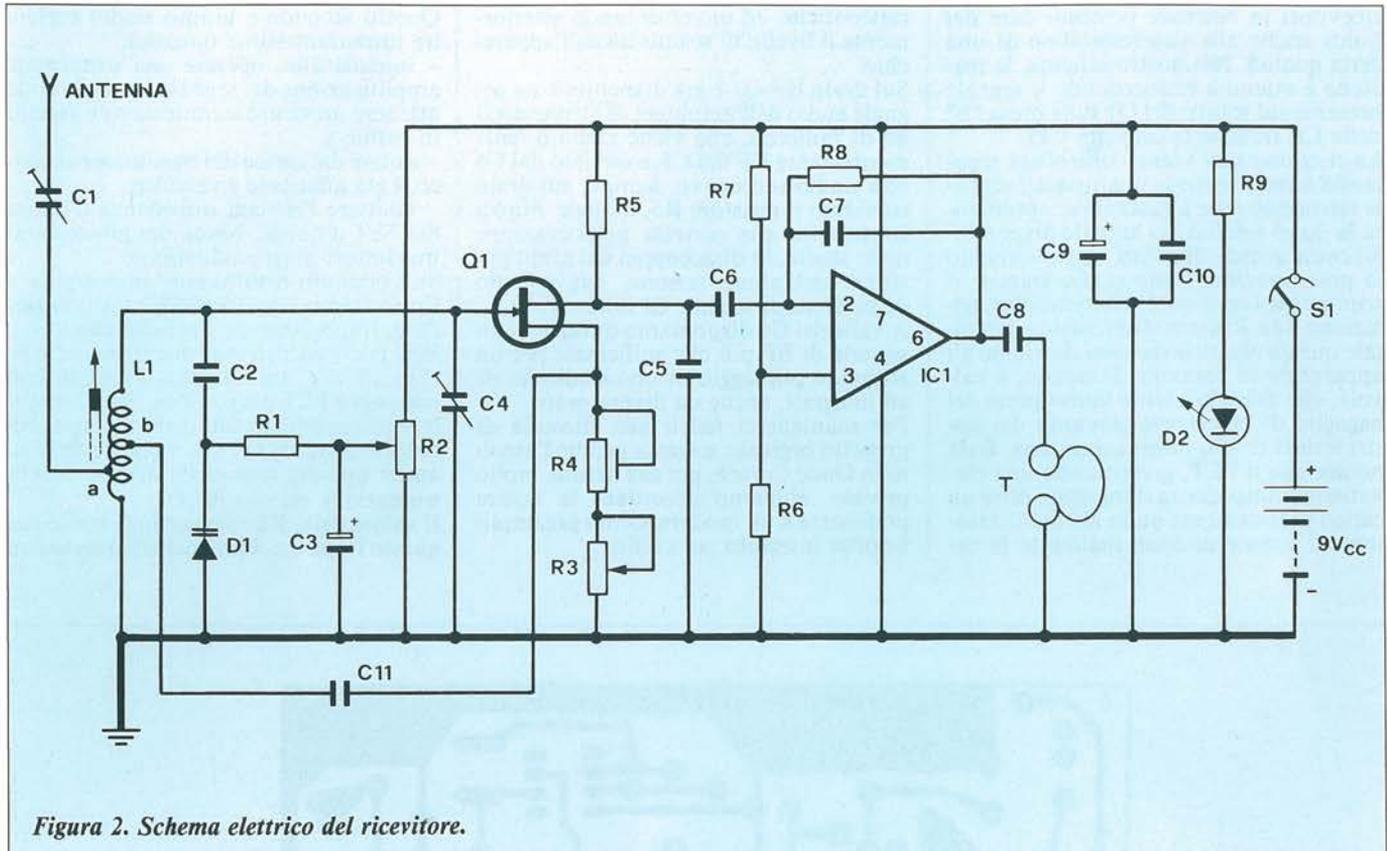
Figura 2. Schema elettrico del ricevitore.
