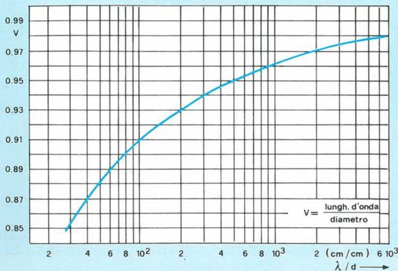
Figura 7. In base al rapporto tra la lunghezza d'onda ed il diametro dello stilo, si può determinare il fattore di accorciamento. Con l'aiuto di questo diagramma è possibile calcolare la lunghezza meccanica in base alla lunghezza d'onda.
