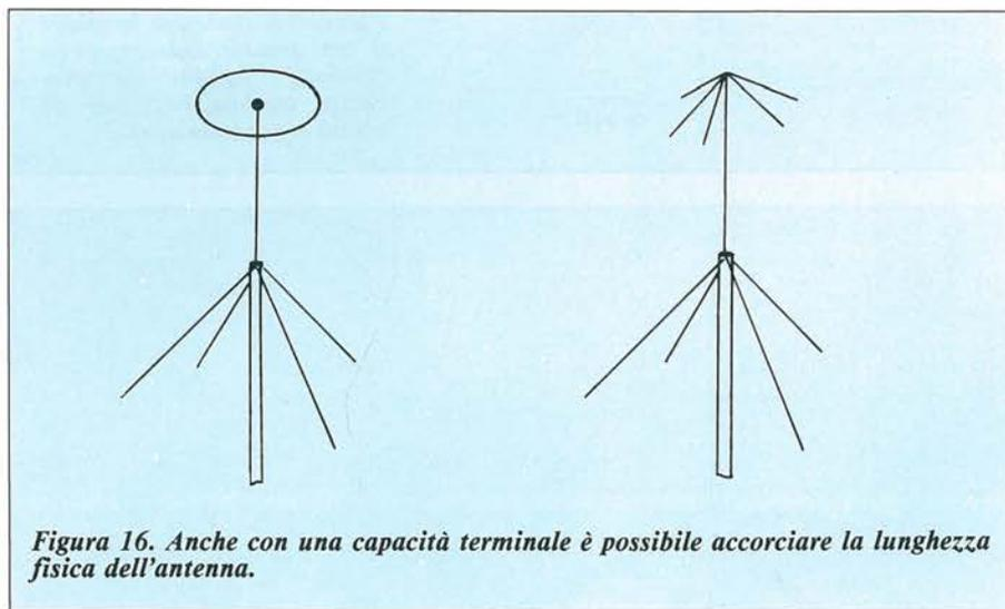
Figura 16. Anche con una capacità terminale è possibile accorciare la lunghezza fisica dell'antenna.
