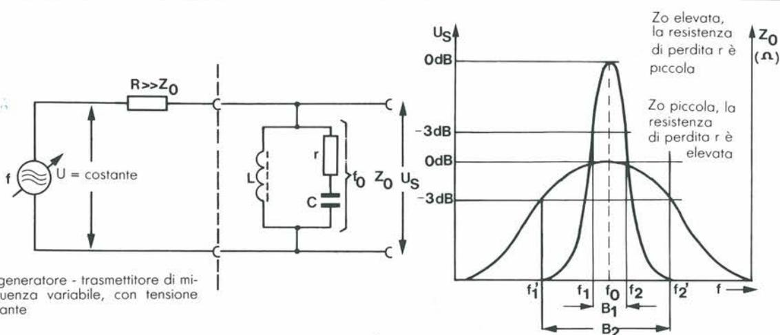
Circuito del generatore - trasmettitore di misura a frequenza variabile, con tensione d'uscita costante
