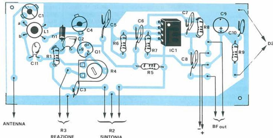
Figura 4. Disposizione dei componenti sul circuito stampato.
