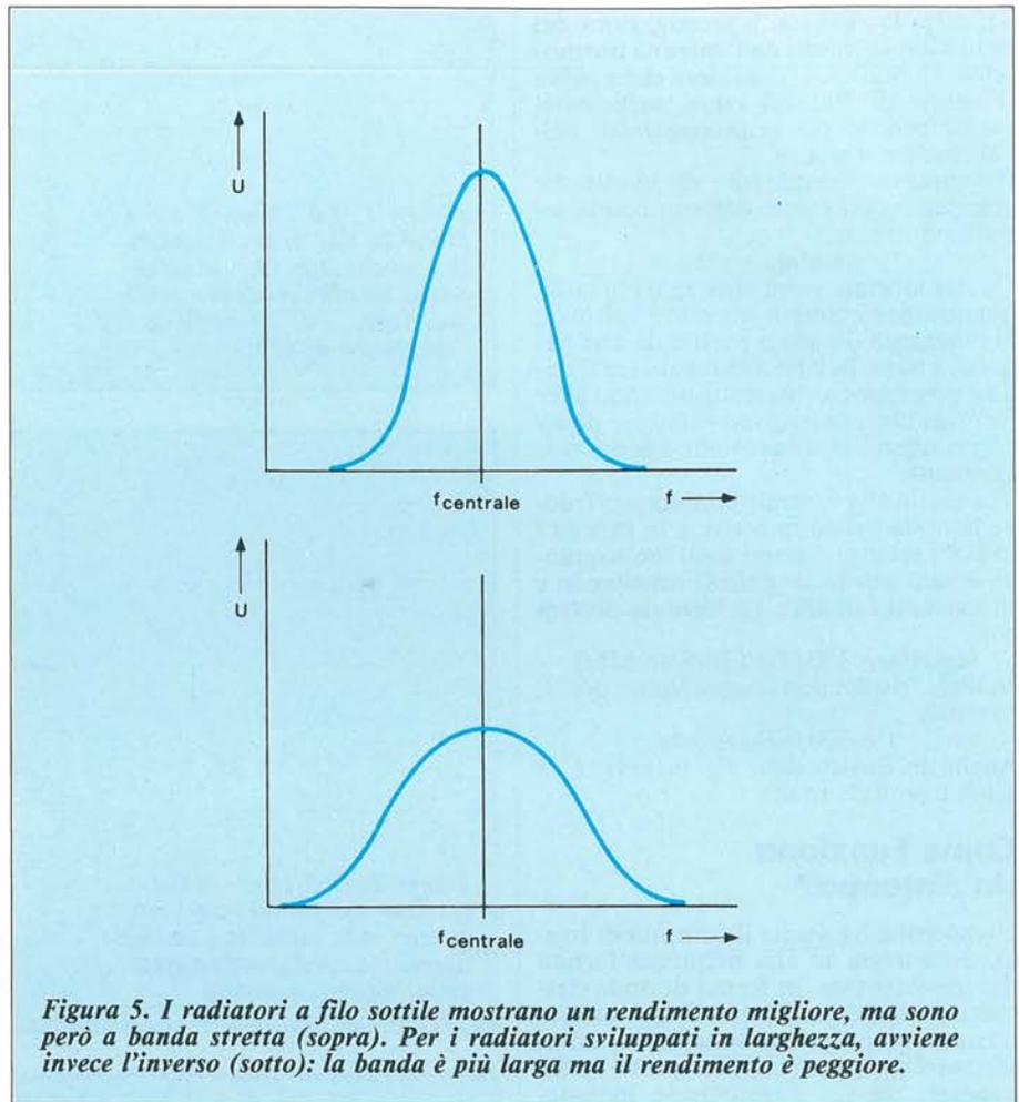
Figura 5. I radiatori a filo sottile mostrano un rendimento migliore, ma sono però a banda stretta (sopra). Per i radiatori sviluppati in larghezza, avviene invece l'inverso (sotto): la banda è più larga ma il rendimento è peggiore.
