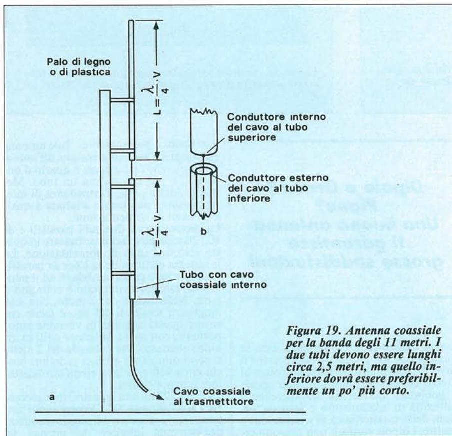
per l'intera lunghezza del tubo inferiore, e solo nel punto più alto di questo la calza di schermo verrà liberata dall'isolamento e saldata al tubo stesso. In questa antenna, la metà inferiore del radiatore ha una doppia funzione: è la metà di un dipolo radiante e contemporaneamente rappresenta, con la parte di cavo coassiale che la attraversa, una sezione di adattamento a quarto d'onda.
