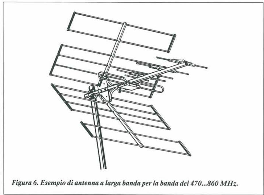
Figura 6. Esempio di antenna a larga banda per la banda dei 470...860 MHz.
