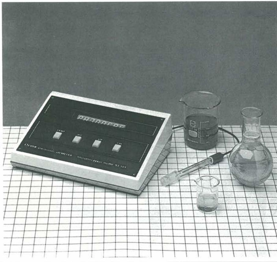
**L**o strumento che verrà descritto in questo articolo è stato originariamente progettato per determinare l'alcalinità dei bagni di sviluppo per le fotografie a colori e, per quanto piuttosto elementare, si è dimostrato più che adeguato allo scopo. Il circuito mette inoltre a disposizione un semplice mezzo per ottenere misure di pH più generalizzate, per i lettori che avessero interesse a svolgere attività nel campo dell'elettrochimica.
