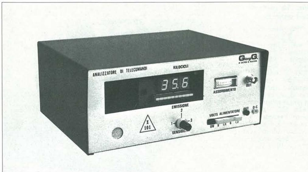
un frequenzimetro digitale a tre digit con circuito anti-pulse per la stabilizzazione delle cifre.
