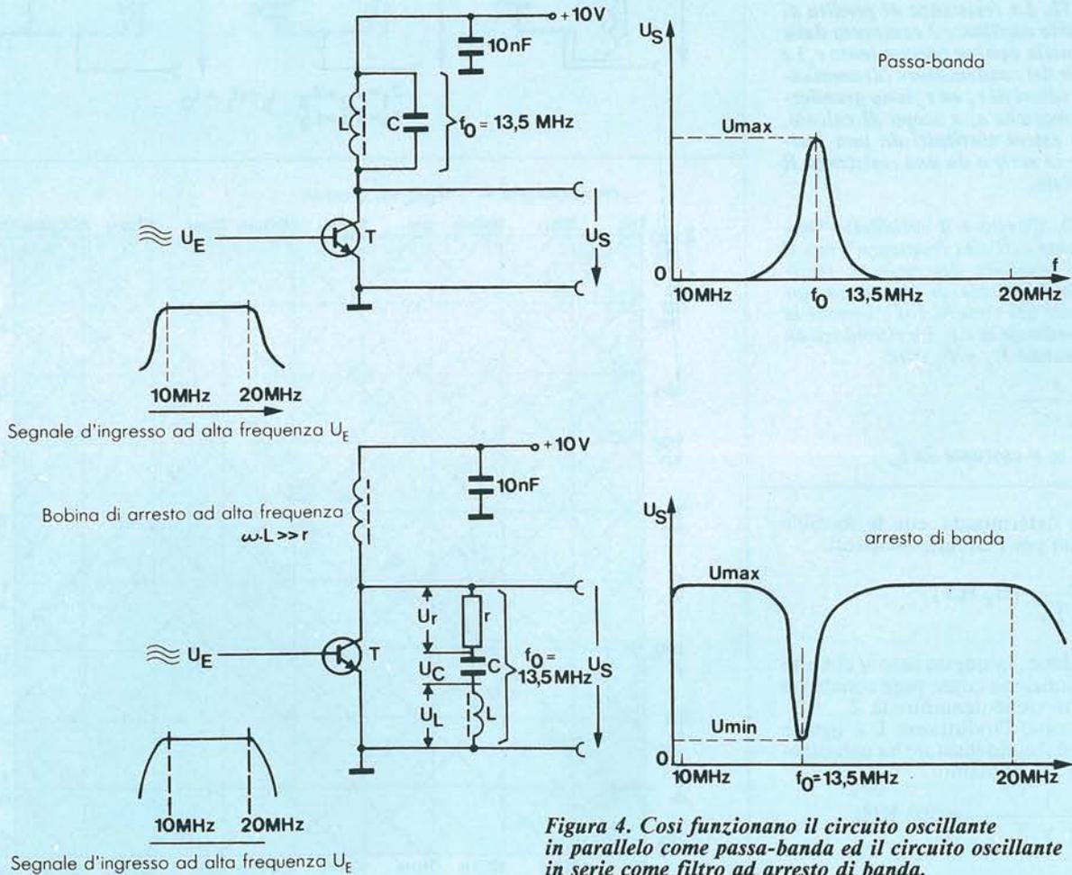
Figura 4. Così funzionano il circuito oscillante in parallelo come passa-banda ed il circuito oscillante in serie come filtro ad arresto di banda.
