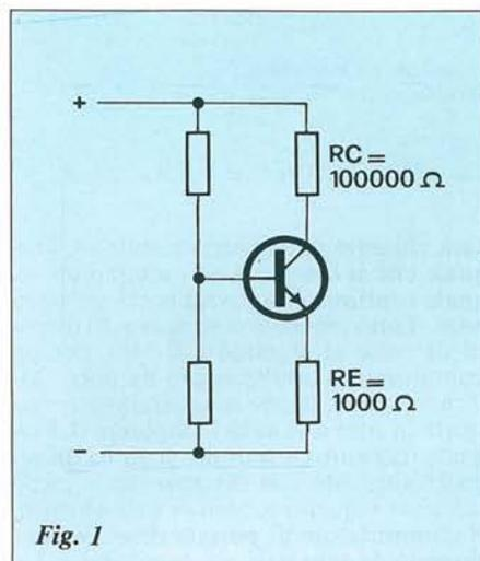
Si ponga il caso che la corrente che percorre il transistor sia da 1 mA. Che la corrente di base sia trascurabile. Si avrà ai capi di RC una tensione  $V = 100.000 R \times 0,001 A = 100 V$ . Se il voltmetro con il quale si fa la misura di tensione in portata 100 V ha una resistenza interna di 1 MΩ, l'errore sarà di circa il 10% in meno. Perché Rc 100.000 con in parallelo 1.000.000 di Ω diventa:
