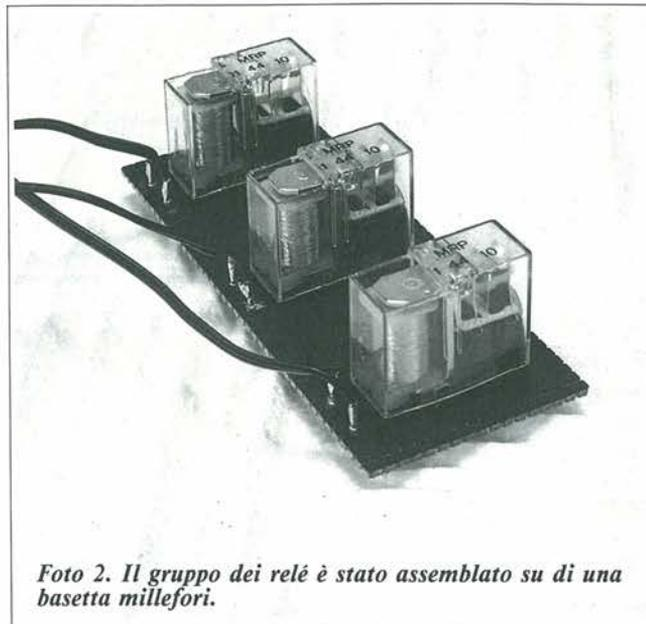
Foto 2. Il gruppo dei relé è stato assemblato su di una basetta millefori.
