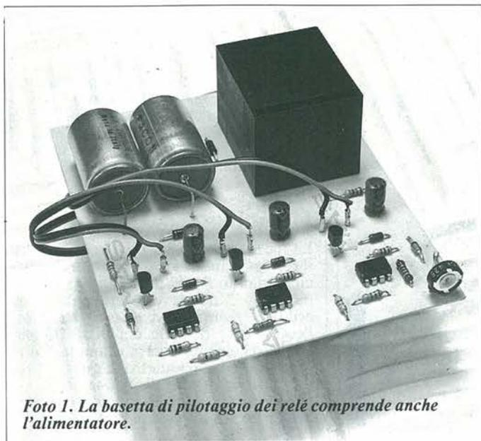
Foto 1. La basetta di pilotaggio dei relé comprende anche l'alimentatore.
