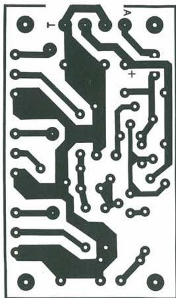
Figura 2. La basetta a circuito stampato. Scala 1:1
