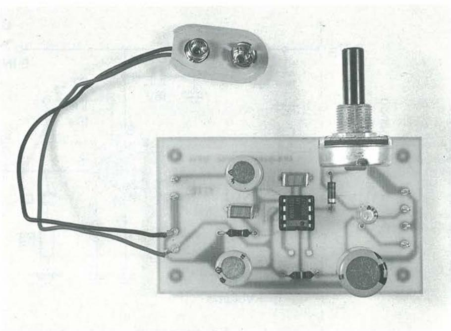
cuito integrato dovrà elaborare la potenza di una sola semionda. Con entrambe le semionde, la potenza ottenuta sarà di 0,5 W. In realtà l'integrato è in grado di erogare fino ad 1 W, ma ciò avviene sol-
