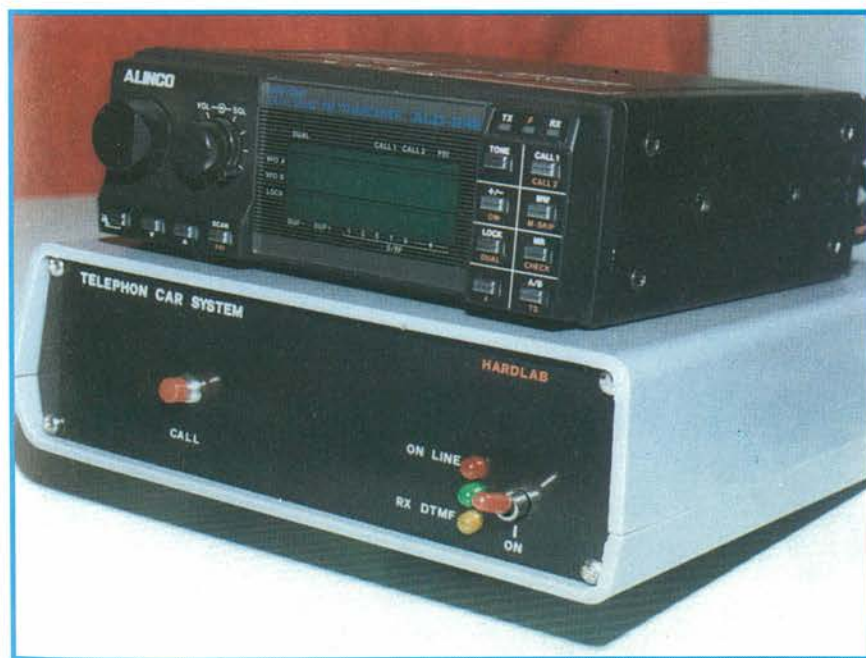
Foto 2. L'interfaccia andrà collegata ad un apparecchio ricetrasmittente possibilmente dual bander. Per le nostre prove abbiamo utilizzato una coppia di ALINCO ALD-24, gentilmente forniti dalla GBC Italiana.
