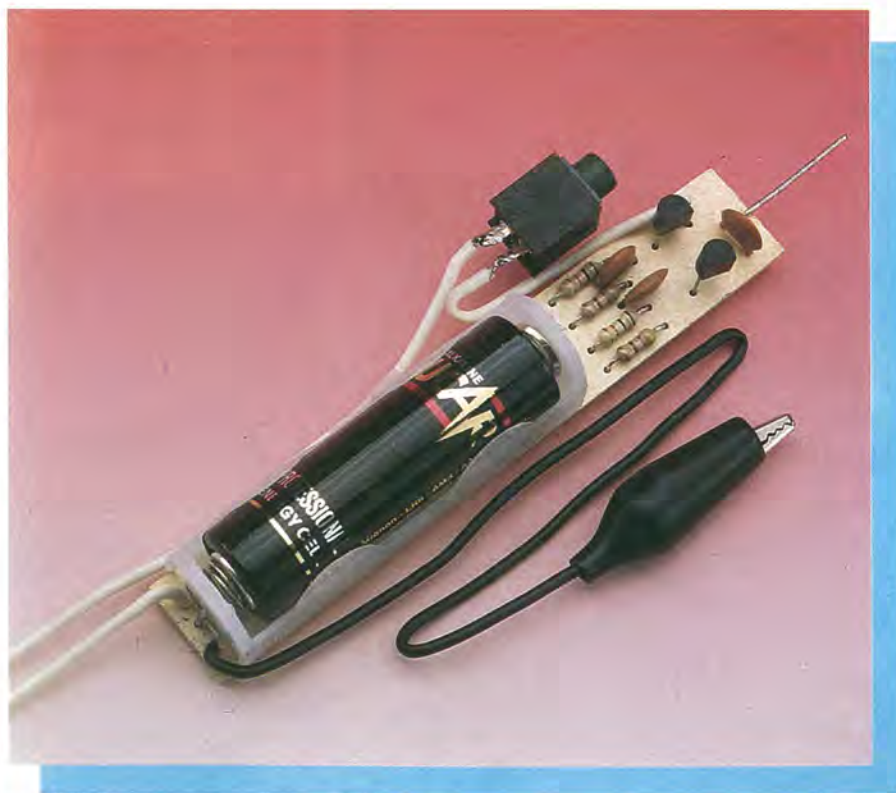
Foto 1. L'iniettore di segnali è utile in tutti quei casi in cui vi siano da verificare guasti in circuiti di amplificazione.
