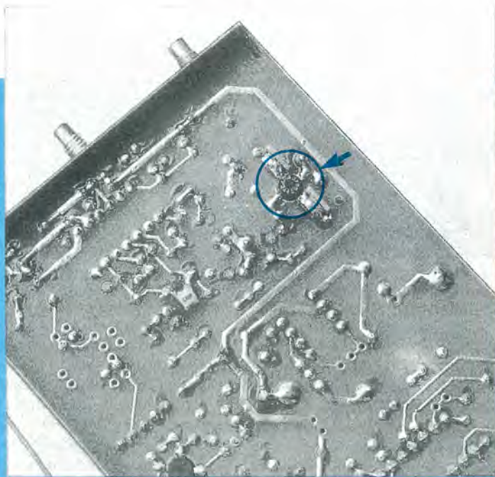
Figura 5. Il transistor d'ingresso T1 verrà montato sul lato inferiore del circuito stampato, come tutti gli altri FET che hanno il contenitore in tecnica SMD
