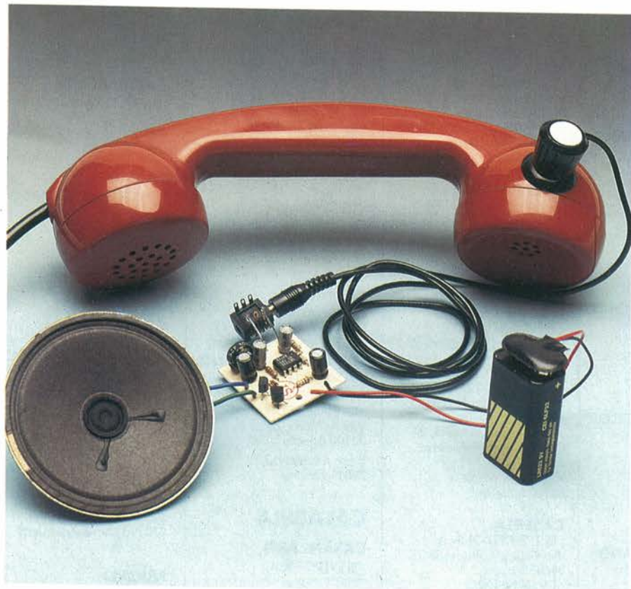
La fotografia è puramente indicativa: il captatore deve essere posizionato in prossimità del trasformatore.
