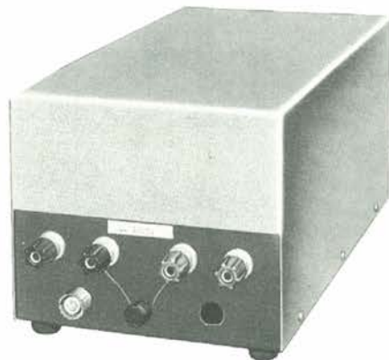
Figura 4. Vista posteriore dell'accoppiatore. Sono visibili i morsetti di collegamento ed il connettore coassiale di ingresso.
