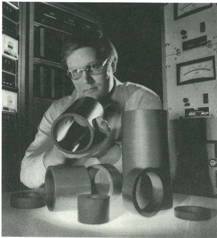
Figura 1. Un ricercatore della General Electric esamina particolari in carburo di silicio ad alta resistenza meccanica e termica, destinati a far parte di macchine o motori auto.
