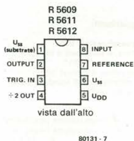
Figura 7. Le connessioni ai piedini sono le stesse per l'R 5609, R 5611 ed R 5612. Al piedino 4 si trova una frequenza metà di quella della tensione di controllo, che rende possibile il controllo di un secondo filtro a soppressione di banda. Questo è molto utile quando si desidera sopprimere le armoniche superiori.
