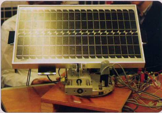
Pontivy - Jeanne d'Arc St Ivy : Panneau solaire suiveur
