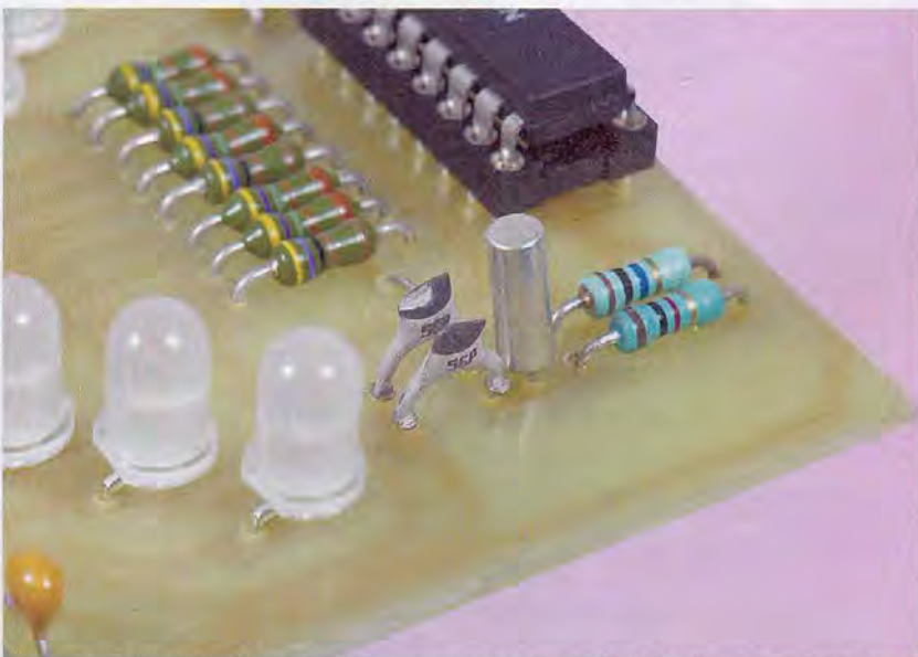
La base de temps est pilotée par un quartz de 32,768 kHz (boîtier métallique rond)
