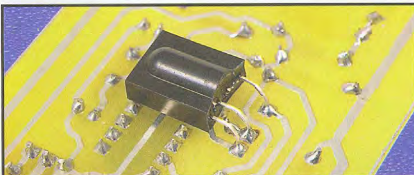
Le récepteur infrarouge placé côté cuivre
