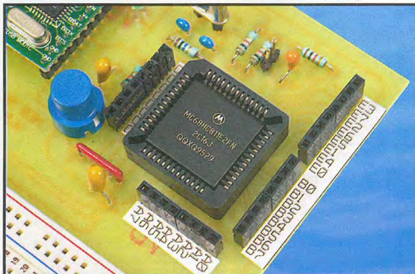
Le microcontrôleur sur support PLCC 52
