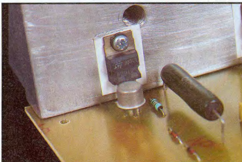
le BD 912 (PNP plaqué contre le dissipateur)
