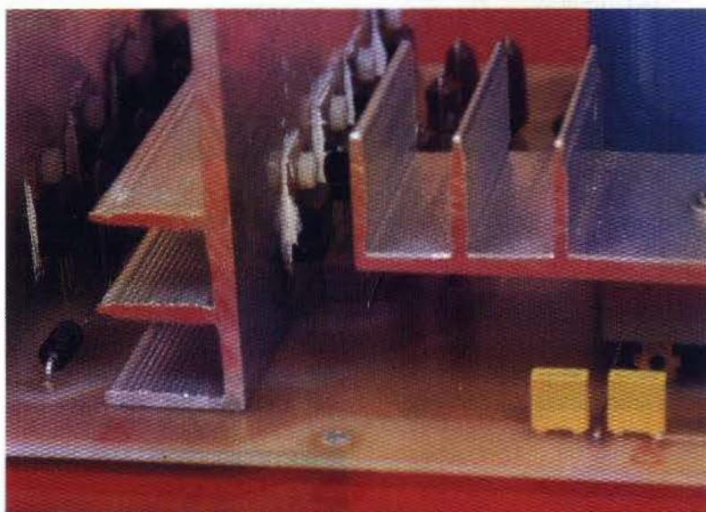
VUE SUR T1, LE TRANSISTOR DE COMMANDE DES REGULATEURS.
