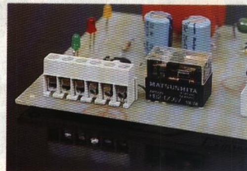
Photo 2. - Ce bornier sert aux connexions avec le thermostat.
