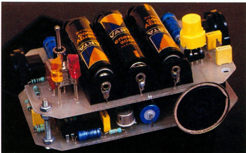
Photo 4. – Vue du coupleur de piles de 1,5 V et du poussoir Isostat monté sur support de C.I.
