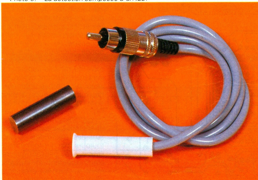
Photo 6. - La détection composée d'un ILS.
