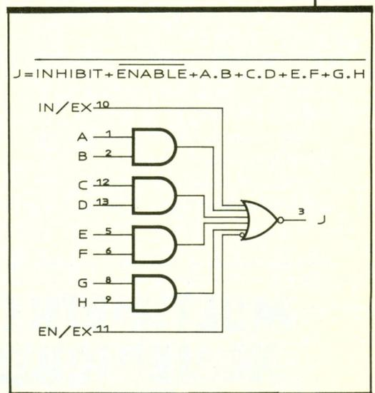
Fig. 2 Diagramme fonctionnel.
