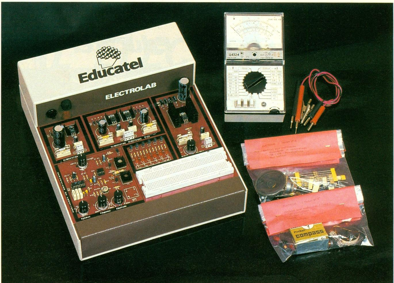
L'Electrolab monté avec l'appareil de mesures et les deux kits d'expérimentation.
