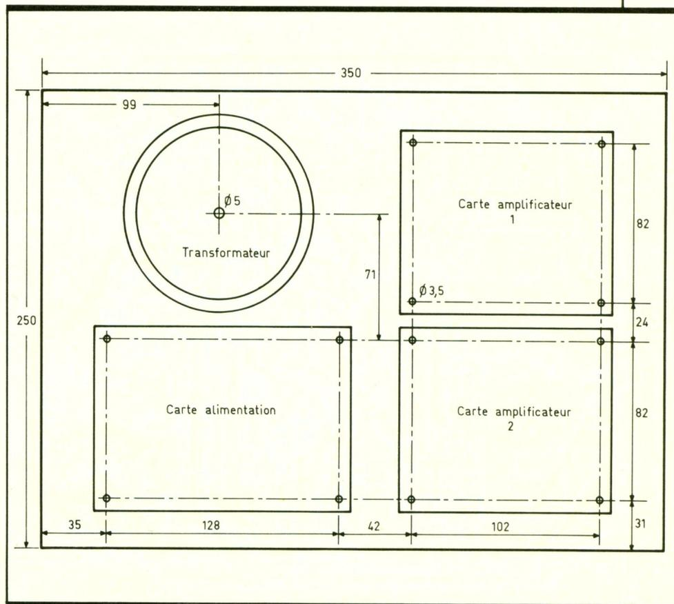
Fig. 8 Agencement à l'intérieur d'un coffret « ESM ».
