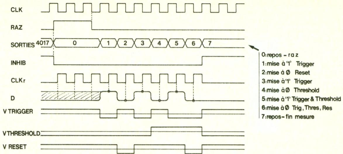
du transistor. Ces deux valeurs se situent de part et d'autre du seuil de basculement le plus défavorable, comme définis par le constructeur. Les éléments  $R_6$  à  $R_{17}$  étant définis pour  $V_{cc} = +15V$ , il faudra les corriger pour d'autres valeurs de  $V_{cc}$ . Chacun des transistors est commandé par une combinaison logique des sorties du 4017. Le résultat de chaque test, fourni par la fonction identité entre Output et Disable (polarisée par
