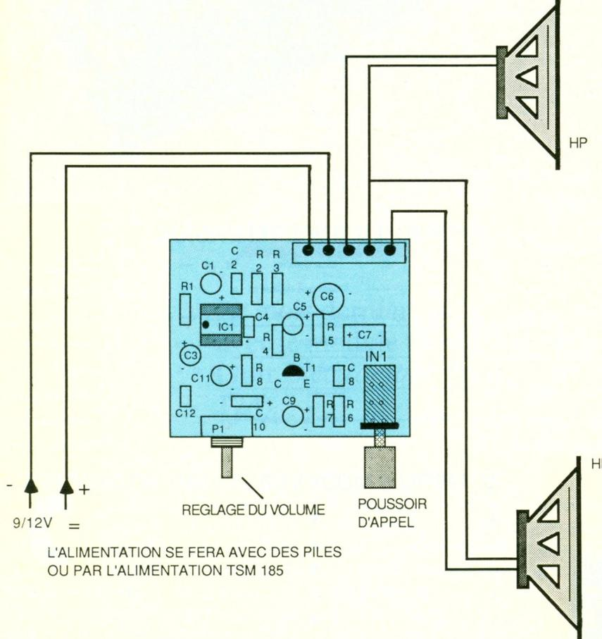
Fig. 1 Schéma de principe complet.
