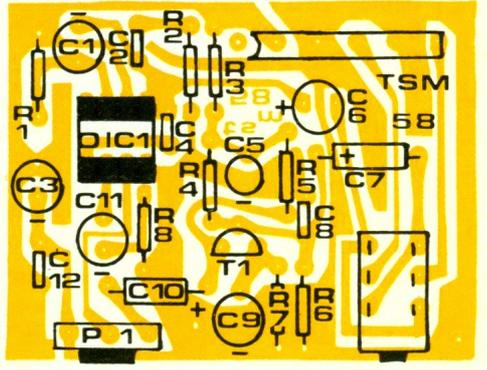
Fig. 2 Tracé du circuit imprimé et implantation à l'échelle et 3
