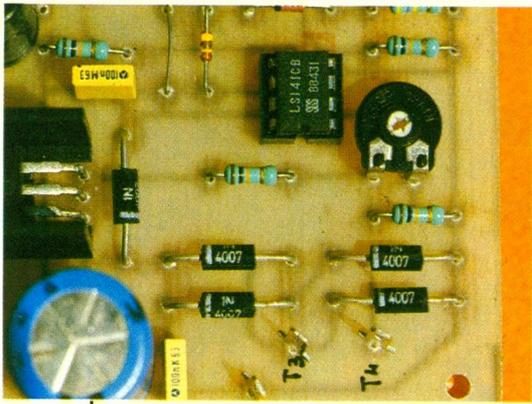
Photo 4. - Gros plan sur les diodes de redressement.
