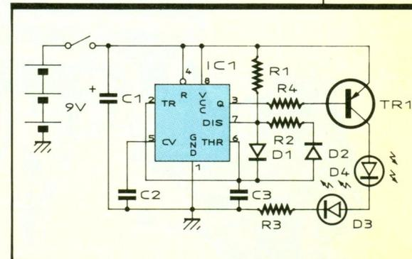
**Fig. 1** Schéma de principe de l'émetteur.
