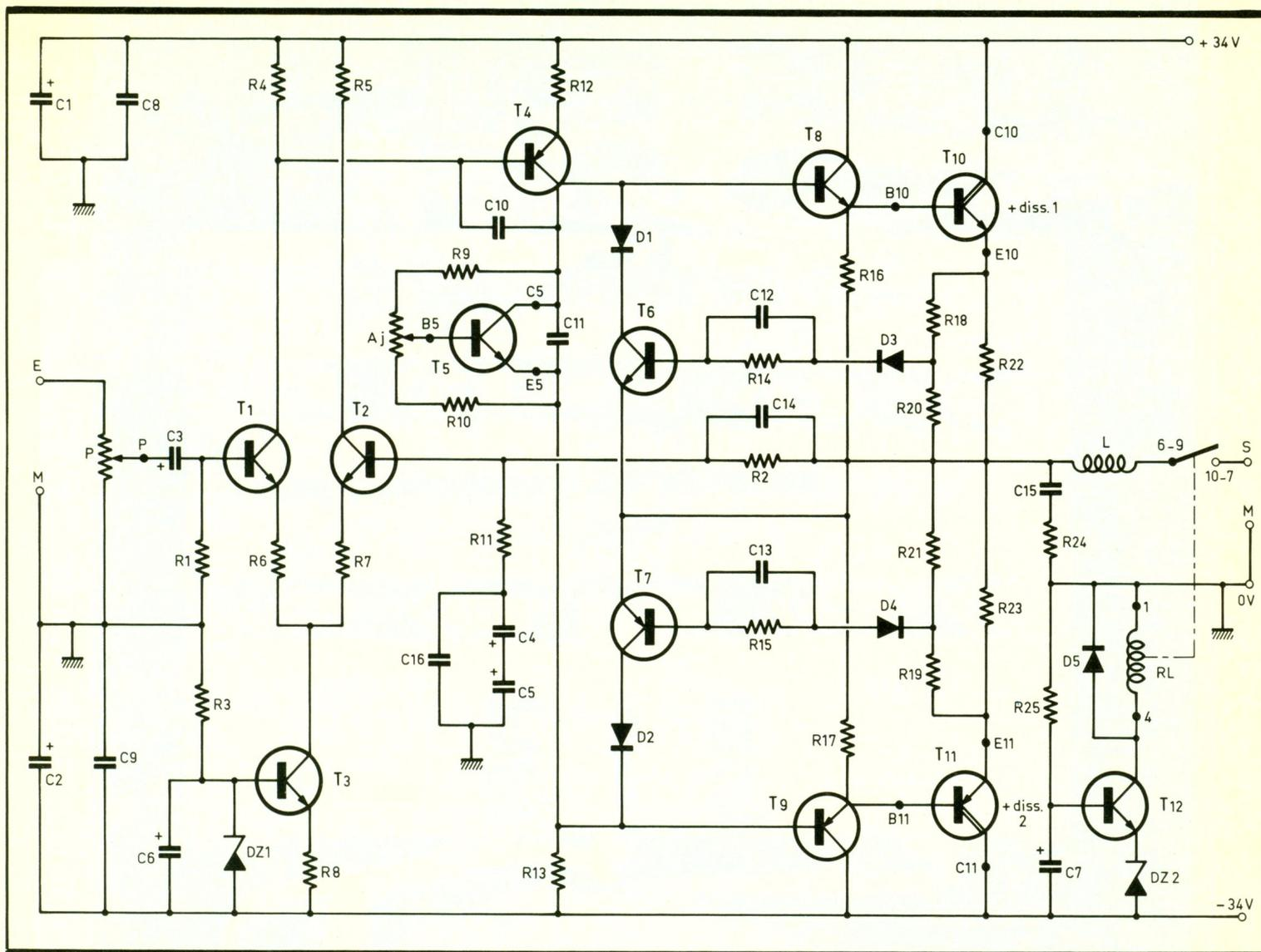
**Fig. 3** Schéma de principe d'un canal.
