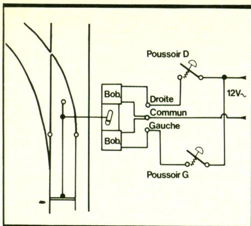
Fig. 1 Fonctionnement d'une aiguille.
