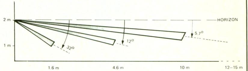
Lentille multicellulaire (vingt-quatre éléments). Grand angle. Détection volumétrique sur trois plans (48 zones de détection). A utiliser avec détecteur pyro-électrique à deux éléments.
