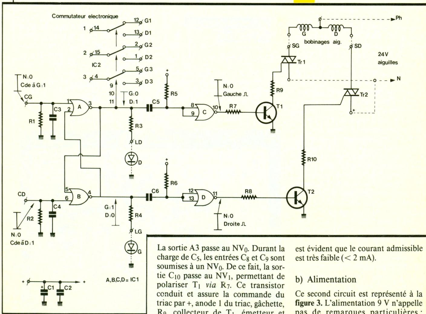
La sortie A3 passe au NV<sub>0</sub>. Durant la charge de C<sub>5</sub>, les entrées C<sub>8</sub> et C<sub>9</sub> sont soumises à un NV<sub>0</sub>. De ce fait, la sortie C<sub>10</sub> passe au NV<sub>1</sub>, permettant de polariser T<sub>1</sub> via R<sub>7</sub>. Ce transistor conduit et assure la commande du triac par +, anode 1 du triac, gâchette, R<sub>9</sub>, collecteur de T<sub>1</sub>, émetteur et
