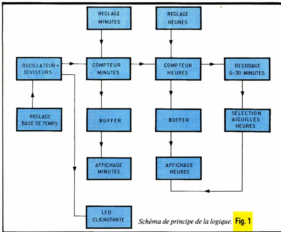
Schéma de principe de la logique. Fig. 1
