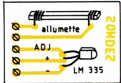
Tracé du circuit imprimé et implantation à l'échelle. **Fig. 5 à 8**
