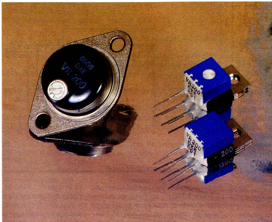
Il est, d'une part, possible d'obtenir toutes les tensions des régulateurs fixes standard avec une meilleure précision et, d'autre part, toutes autres tensions particulières avec la commodité de retouches pour mise au point des circuits ou pour leur maintenance.
