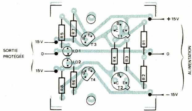
« moins ». Si le gain en courant statique de  $T_1$  est de  $B = 100$ , et si on prévoit une limitation à  $I_C = 30$  mA, on s'arrange pour que  $I_B = I_C/B = 30/100 = 0,3$  mA. Tant qu'on demande moins de 30 mA en sortie, le transistor restera saturé, et la chute de tension émetteur-collecteur est négligeable.
