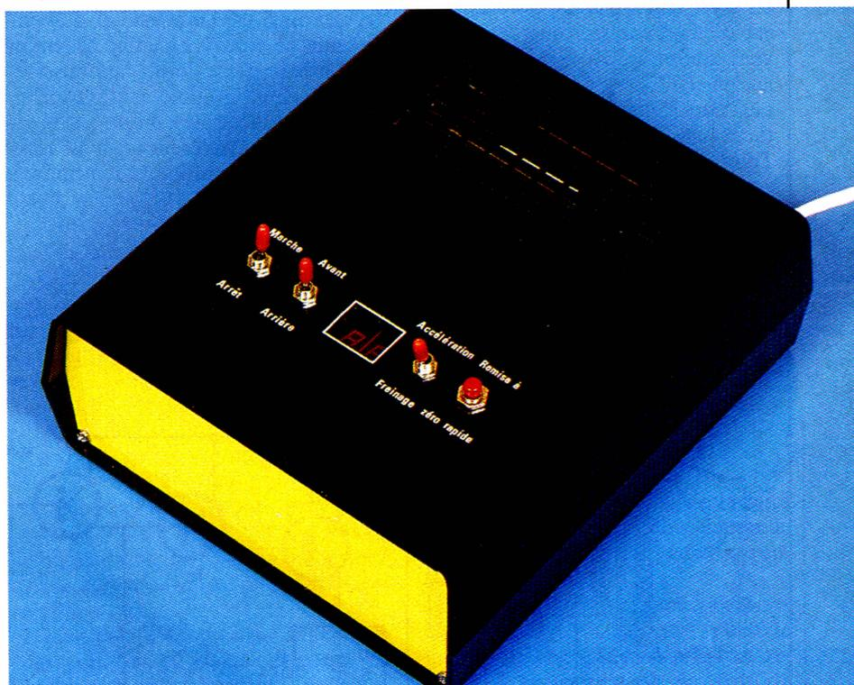
Le potentiel ainsi généré est amplifié en intensité pour être disponible en définitive sur la sortie de l'alimentation de puissance. Un fusible à fusion rapide protège le montage contre les surintensités et les courts-circuits éventuels. De plus, un inverseur manuel à trois positions (deux actives et une neutre) permet l'inversion du sens de marche du train. Enfin, un
