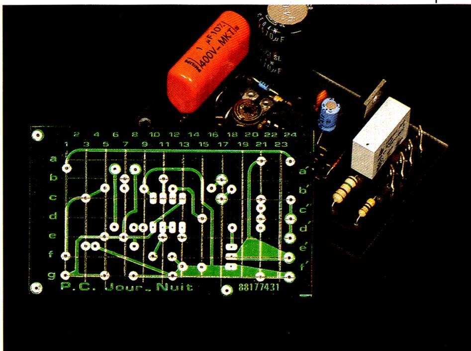
à l'aide de la méthode Transpage, vous permettra de réaliser votre circuit sur plaque présensibilisée. Vous pouvez aussi sensibiliser une plaque cuivrée à l'aide d'une résine photosensible en aérosol. Dans les deux cas, il est prudent d'étamer le circuit après gravure et rinçage.
