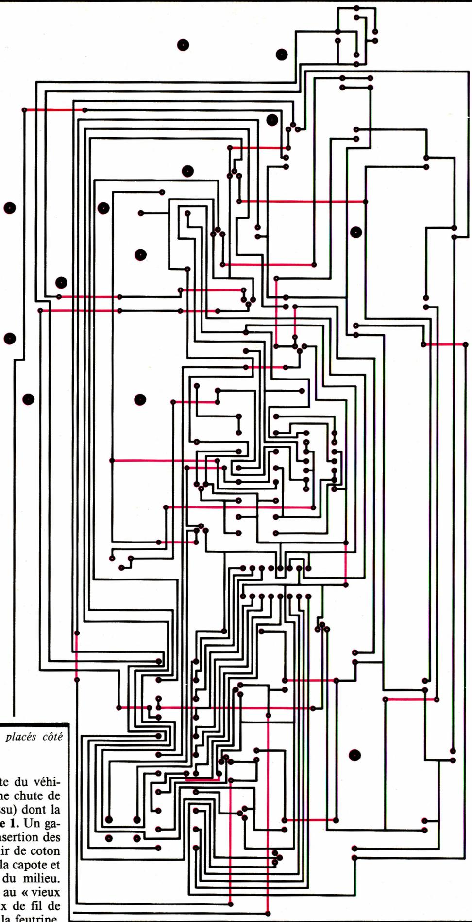
**Fig. 5** *Position des straps placés côté « soudure ».*
