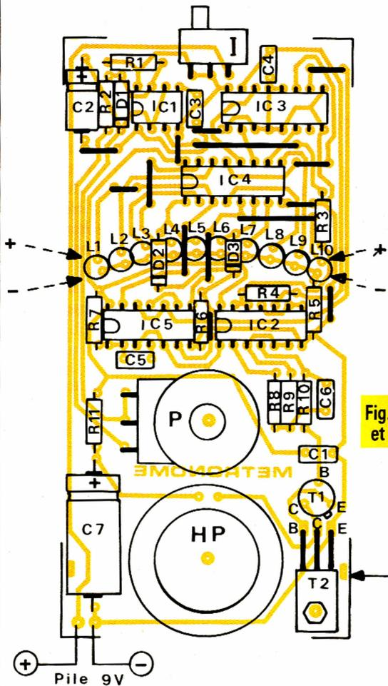
**Fig. 6** et **7** Tracé du circuit imprimé et implantation des éléments.
