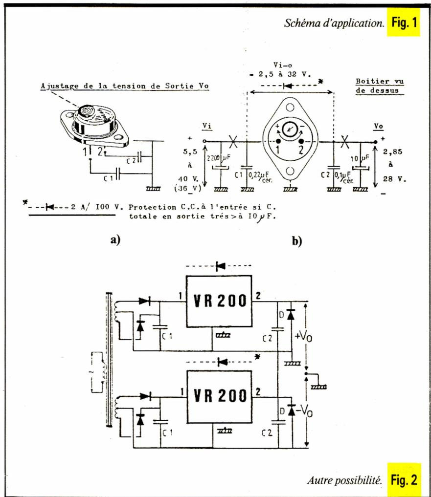
tement lissée; un condensateur de 2 200 à 3 300  $\mu$ F en sortie de redresseur double alternance sera nécessaire pour un courant de 2 A à 20 V. Pour une tension de 10 V, cette valeur devra être doublée.
