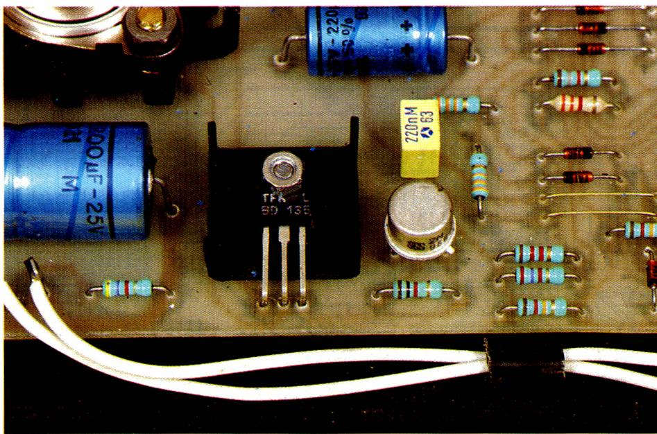
Photo 4. – Autre transistor de puissance BD 135.
