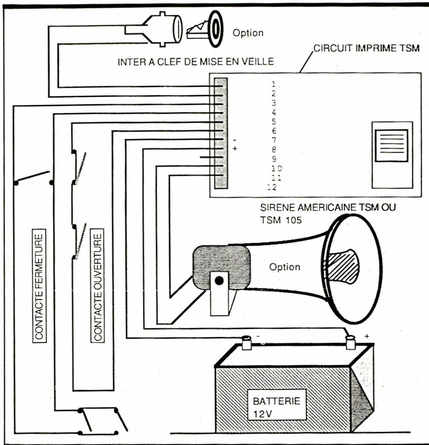
2 du connecteur. Lorsque les bornes 1 et 2 sont court-circuitées, l'alarme est hors service ; lorsqu'elles ne sont pas reliées, l'alarme passe en position veille. Cet interrupteur sera monté sur la face avant du boîtier.
