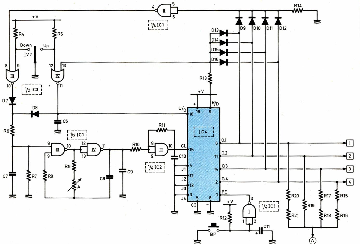
**Fig. 3** Commande de la graduation.
