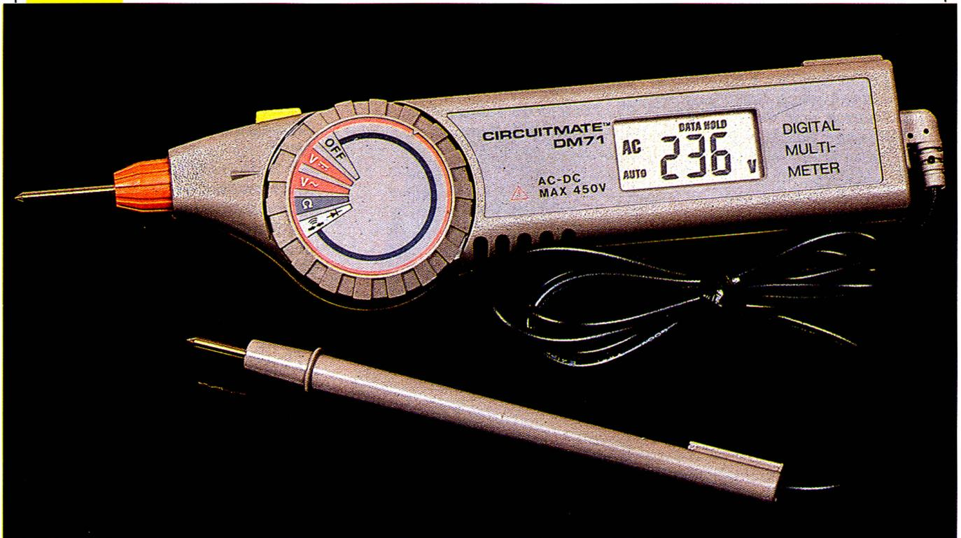
**C**eci n'a pu être obtenu que par l'utilisation d'un circuit C-MOS du type LSI (intégration à grande échelle) et par la technique de montage des composants en surface. Un seul et unique circuit intégré assure les fonctions : convertisseur analogique/digital, driver de l'affichage à cristaux liquides et gestion automatique des calibres.
