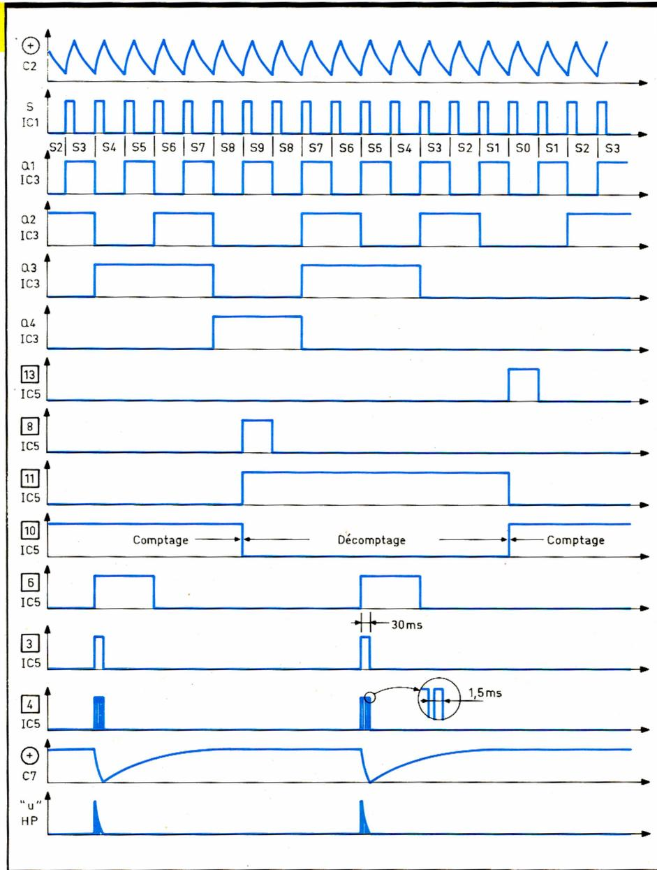
bas, la sortie présente un état bas permanent de repos. Par contre, dès que l'entrée de commande se trouve reliée à un état haut, le multivibrateur entre en oscillation et délivre sur sa sortie des créneaux d'une période de l'ordre de 1,5 ms, ce qui correspond à une fréquence de 660 Hz, c'est-à-dire une fréquence dite musicale.
