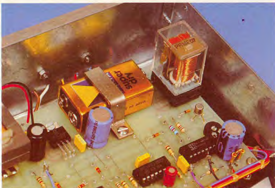
Photo 3. - Etrier de fixation de la pile 9 V.
