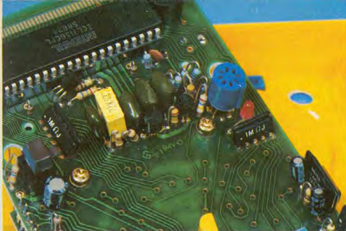
Photo 4. - Le convertisseur analogique/numérique ICL 7136, d'Intersil, constitue le cœur du système.
