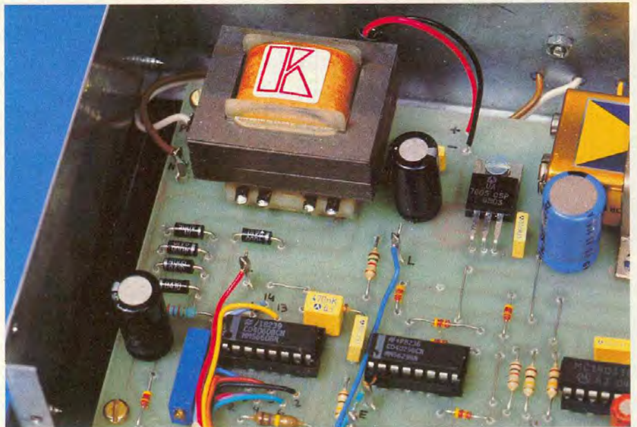
Photo 4. - Section alimentation avec son circuit régulateur.
