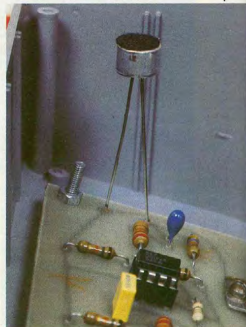
Fig. 2 Schéma de principe. Aspect du micro « électret ».
