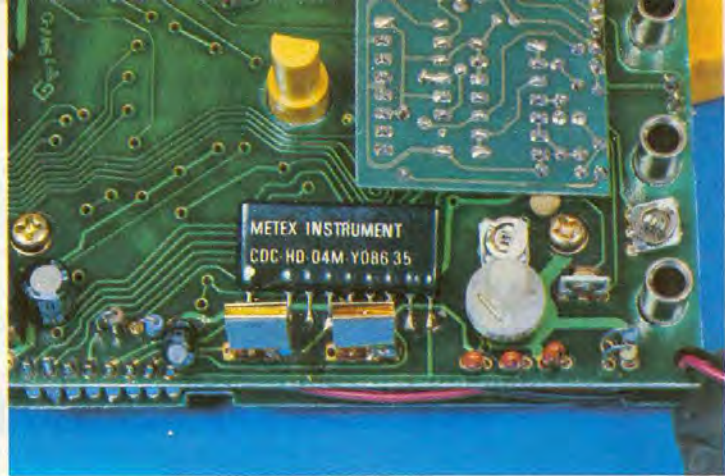
Photo 5. - Le Metex utilise un réseau intégré de résistances de précision. A droite, le potentiomètre de réglage de zéro du capacimètre.
