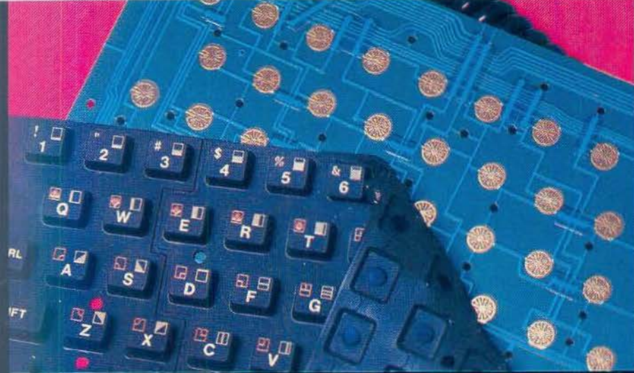
Photo 5. – Le clavier séparé vu de l'intérieur, montrant la structure en « tapis caoutchouc » et l'aspect du circuit imprimé.
