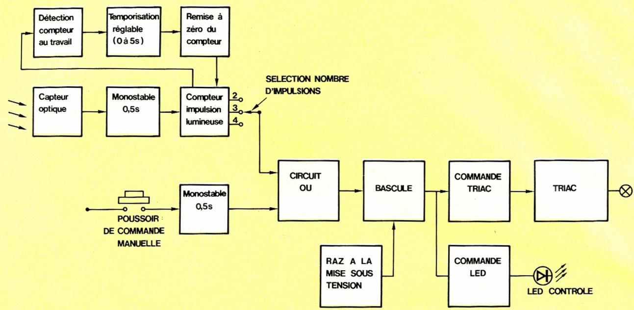
**Le synoptique laisse apparaître l'emploi d'un capteur, en l'occurrence une classique LDR. Un monostable permet de détecter les impulsions trop longues.**
