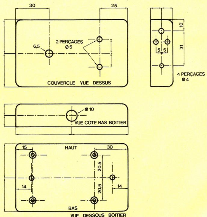
**Le montage pourra s'introduire à l'intérieur d'un coffret en aluminium de 120 × 40 × 30 mm. On procédera alors à quelques perçages, notamment pour la mise en place du transistor de puissance.**
