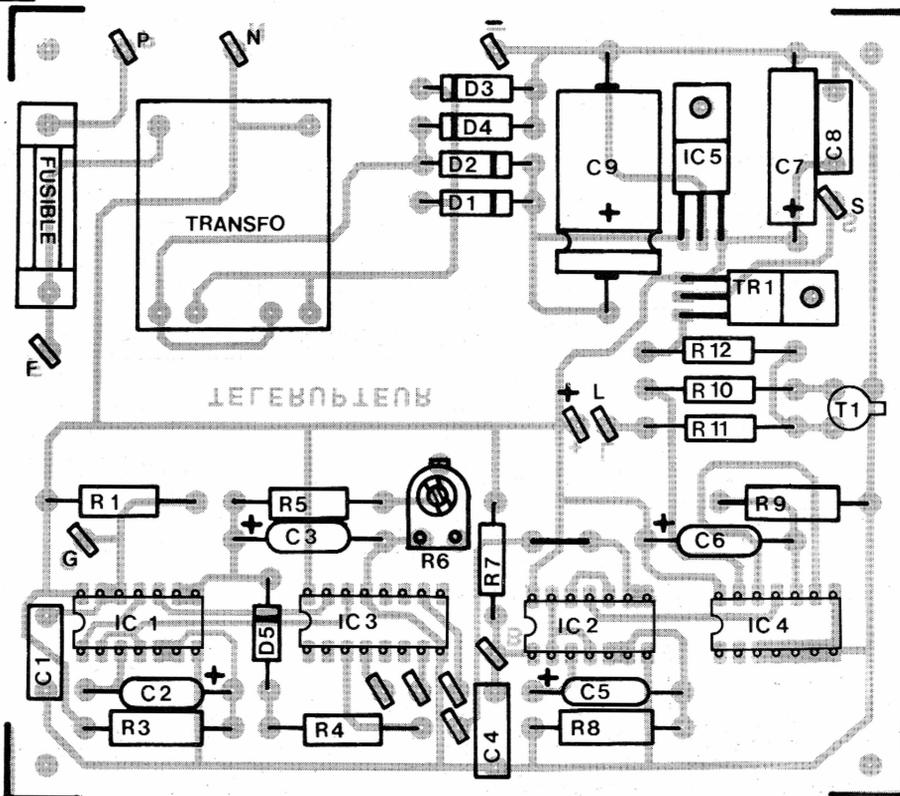
**Le tracé du circuit imprimé publié grandeur nature se reproduira facilement à l'aide d'éléments de transfert Mecanorma. Implantation pratique des éléments. Attention au strap de liaison.**
