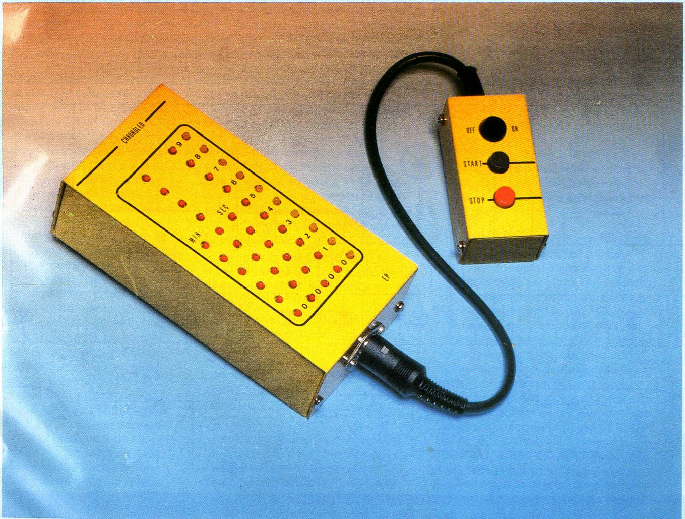
La durée maximale comptabilisée sera d'une heure exactement, avec une précision de 1/10 de seconde.
