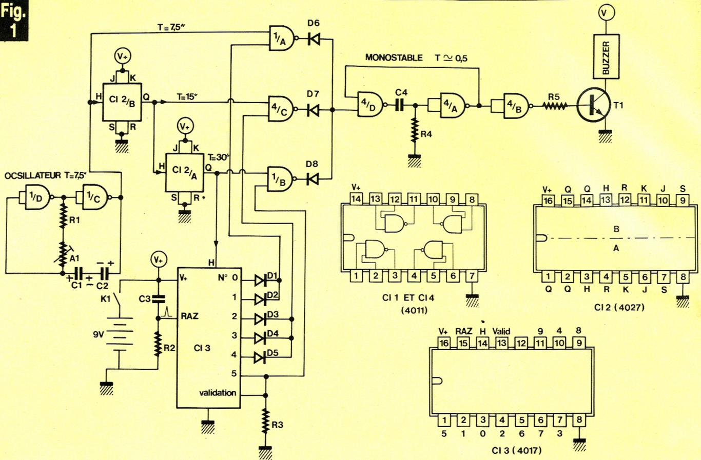
**Le cycle de tops sonores de plus en plus espacés s'obtient à l'aide de circuits intégrés logiques C MOS : portes NAND, bascules JK et compteur.**
