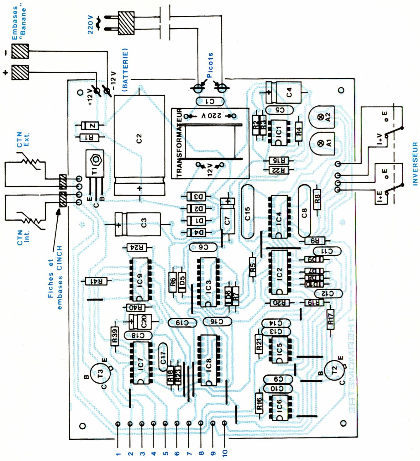
Le tracé du circuit imprimé publié grandeur nature se reproduira plutôt par le biais de la méthode photographique. Il conviendra, côté implantation des éléments, de bien orienter les méplats des divers circuits intégrés.
