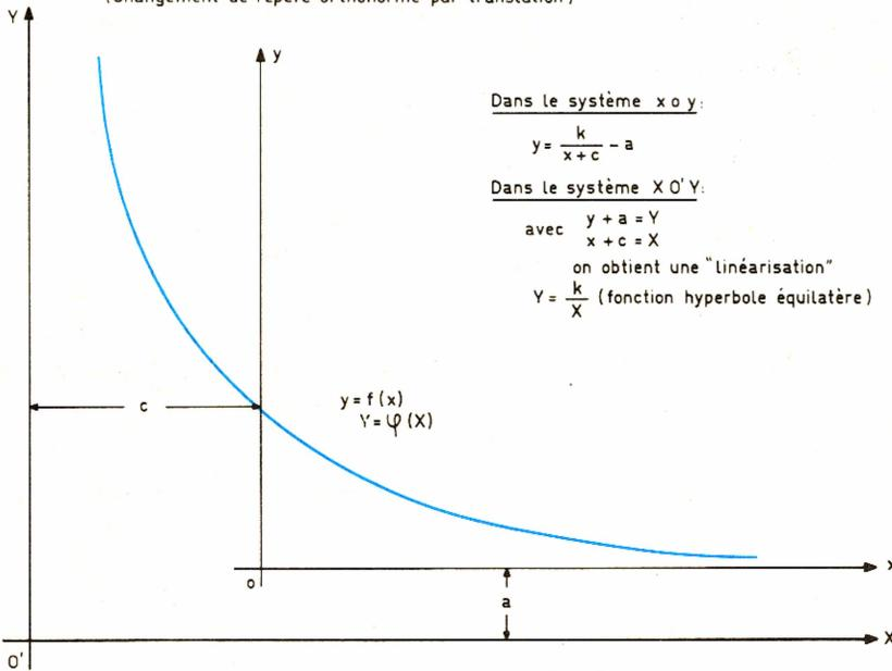
L'exploitation de la mesure de la résistance de la CTN pour en déduire la valeur de la température nécessite, bien sûr, une correspondance linéaire entre les paramètres.
