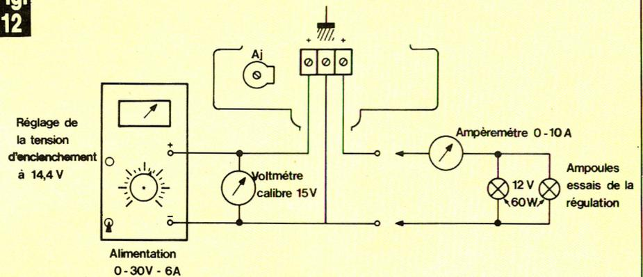
**A l'aide d'une alimentation stabilisée, et d'un voltmètre, on étalonnera le montage.**
