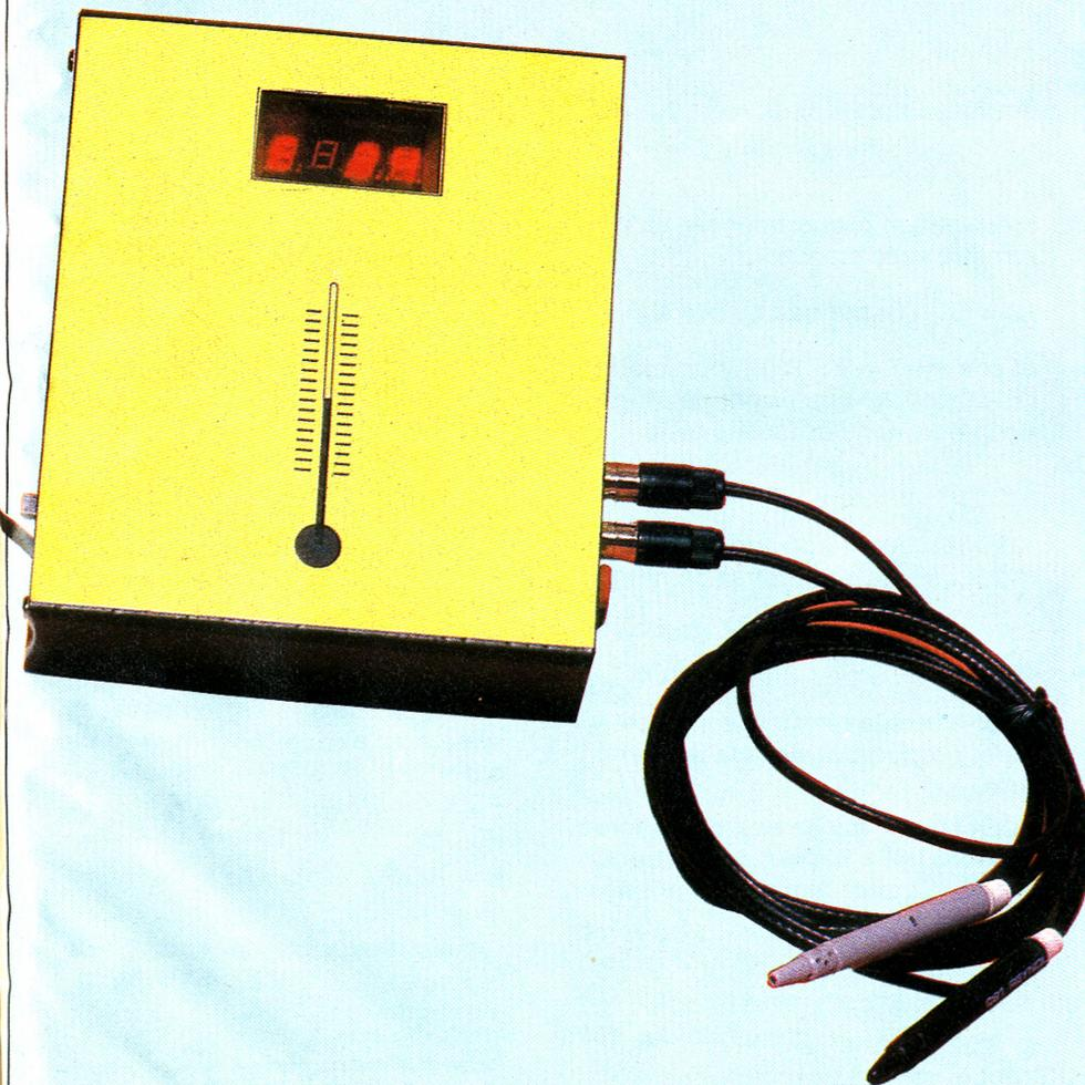
**E**ntièrement équipée de composants courants, cette réalisation de télémessure offre une précision tout à fait remarquable pour les températures courantes allant de  $-15^{\circ}\text{C}$  à  $+40^{\circ}\text{C}$ .
