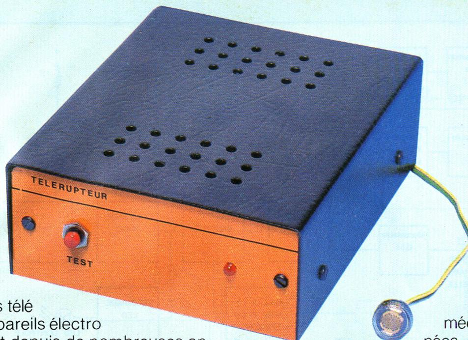
Les télé-appareils électromécaniques existent depuis de nombreuses années. Un bouton-poussoir attire une palette qui établit un contact : la lampe s'allume. Une seconde impulsion remettra le système au repos.
