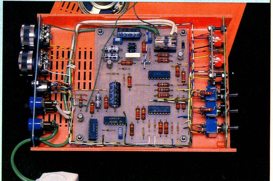
Si votre horloge est secourue, on utilisera à profit les deux tensions VS et V. A défaut, ces deux tensions seront reliées ensemble sur la maquette. Ceci entraînera alors la suppression de : R<sub>21</sub>, R<sub>22</sub>, T<sub>3</sub>, C<sub>5</sub>.
