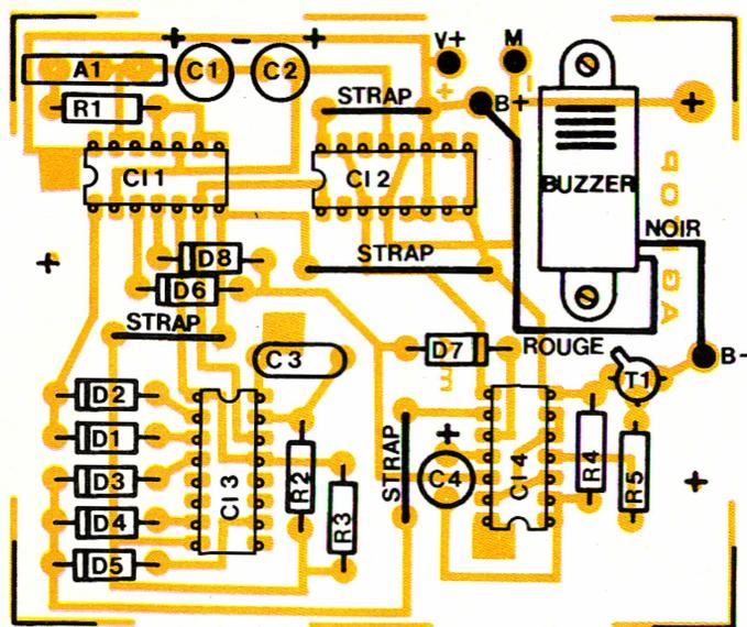
**Le tracé d'un circuit imprimé se reproduira facilement à l'aide d'éléments de transfert Mecanorma. Ne pas oublier les quatre « straps » de liaison.**
