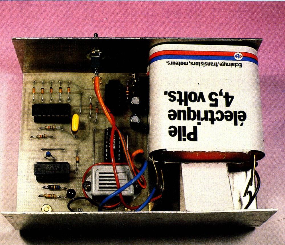
*Les dimensions de la carte imprimée permettent de loger deux piles 4,5 V à l'intérieur du coffret.*
