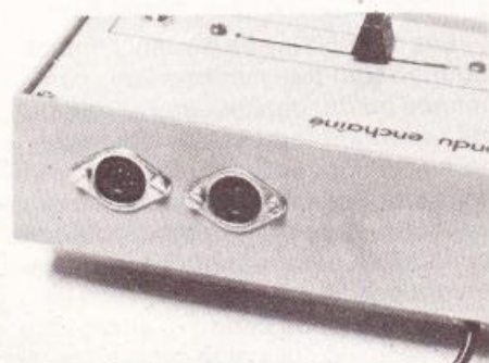
Photo 3. - Les deux prises de sortie destinées aux projecteurs.
