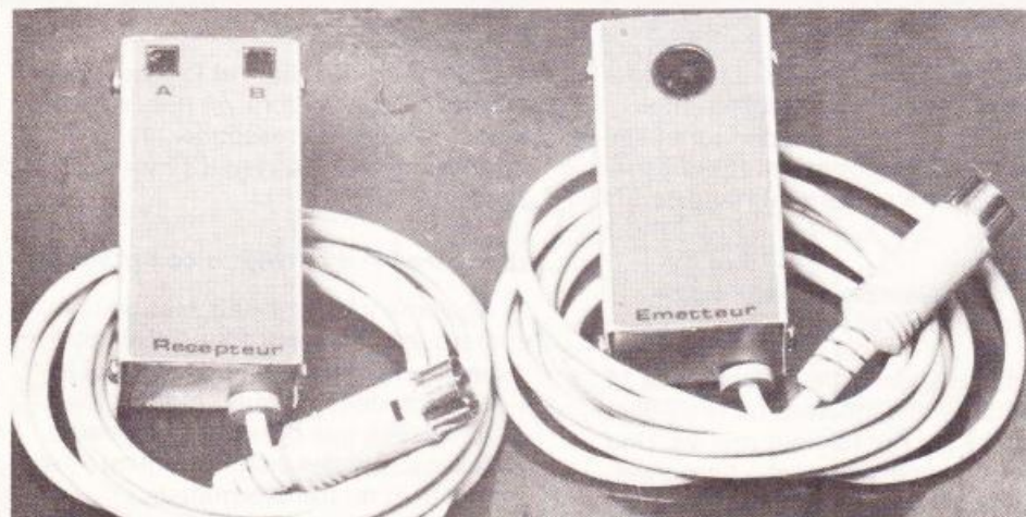
Photo 6. – Des prises DIN et du fil blindé permettront d'éloigner l'émetteur du récepteur.
