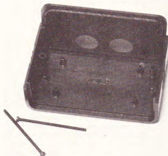
Photo 5. — Le coffret MMP présente l'avantage d'un démontage total.
