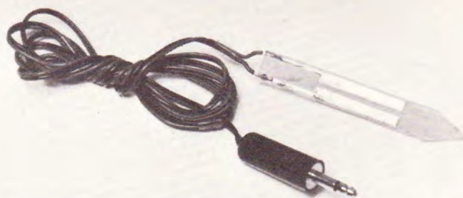
Photo 2. — Gros plan sur les éléments câblés en l'air, du testeur d'humidité.
