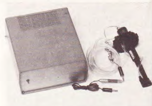
Photo 5. — Le boîtier Teko, et la pompe de lave-glace de marque Renault.
