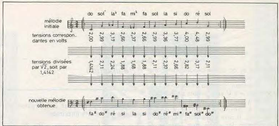
Fig. 6. - Principe de la transposition par division de la tension de sortie.
