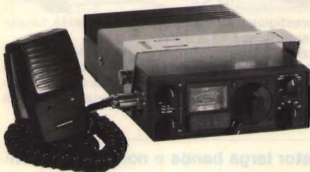
SOMMERKAMP mod. TS788 DX 12.000 canali 26/30 MHz AM FM USB LSB CW, potenza nominale 100 W ridotta 10 W-Shift per ripetitore 10 mt. memoria sulla frequenza TX-RX, selezione volume clarifier scanner sul micro.
