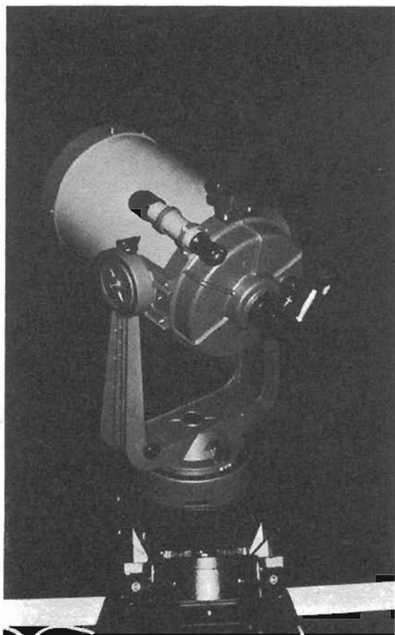
Telescopio a specchio Schmidt-Cassegrain. Ø 20 cm, focale 200 mm. Nella base, sotto la « forcella », il motore sincrono per il moto orario.
