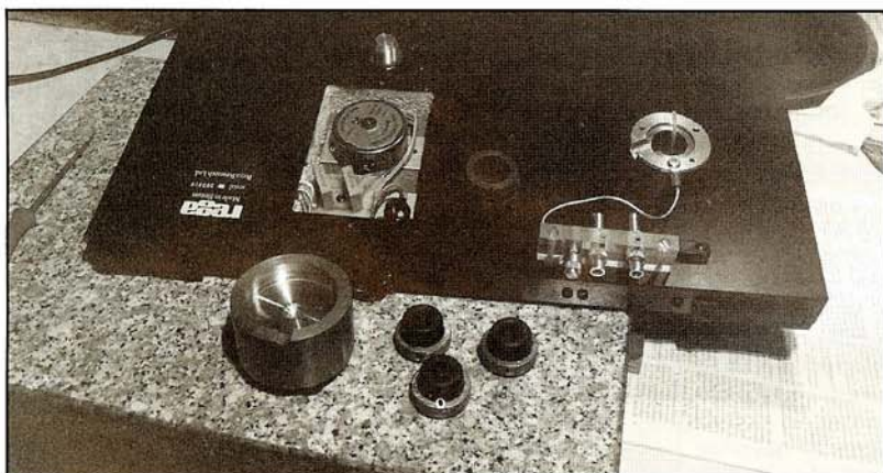
Foto A - Il coperchio che nasconde il motore è stato rimosso, in modo da rendere visibile il montaggio originale del motore. Davanti al giradischi si vedono il cilindro di piombo preparato per accogliere il motore e le prolunghe per i piedini. Sulla destra si vedono il portaconnettori in metacrilato e la flangia di bloccaggio della base del braccio.
