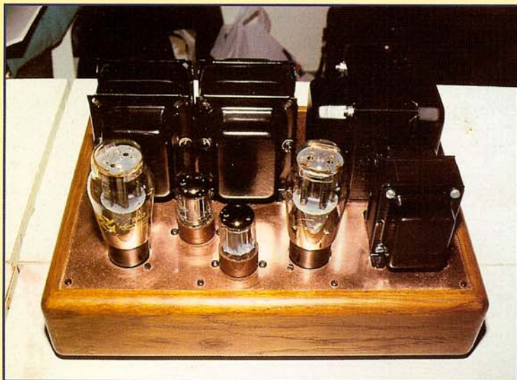
Fronte e retro del Triodino 3 (ver. 2A3 "base") con pregevole base in rovere di Slavonia e pannello superiore di rame elettrolitico; si notano i due interruttori separati per la rete e per l'anodica, i massicci 3 trasformatori, la capace induttanza di filtro ed i connettori d'ingresso e d'uscita.
