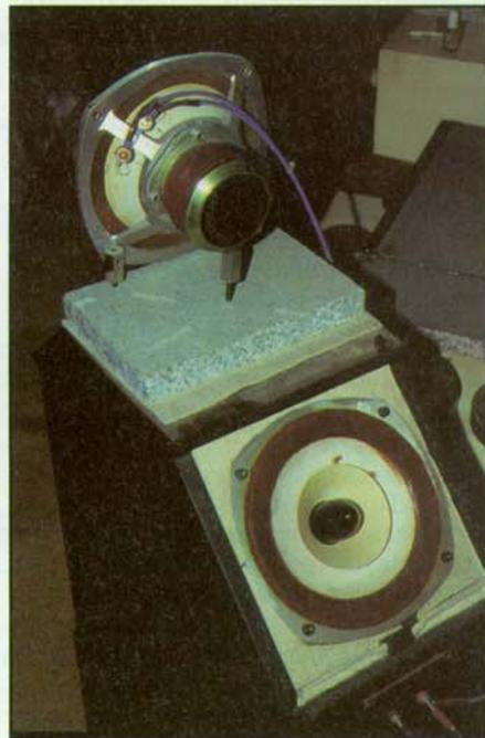
Vista posteriore di uno dei due diffusori: l'altoparlante posteriore, un PM7A, è stato modificato nelle sospensioni ma l'ogiva non è stata rimossa. Si noti anche il montaggio dell'altoparlante superiore, un PM6A MK1, accoppiato al box inferiore tramite punte di acciaio che poggiano su di una lastra di granito.
