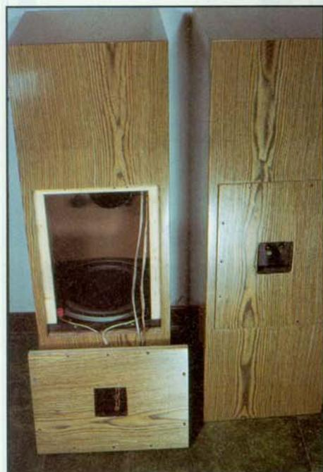
La flangia superiore del woofer serve anche per dividere la parte chiusa da quella reflex nel simmetrico. Il condotto di accordo, realizzato in PVC, è stato trattato con antiribomballo allo scopo di attenuare eventuali risonanze. I mobili sono in MDF da 2 cm rivestiti in frassino ed hanno dimensioni esterne di cm 90 x 29 x 31.
