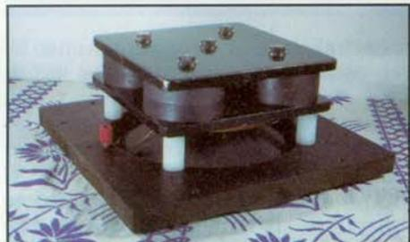
L'uso delle viti inox si è reso necessario per evitare dei corto circuiti magnetici.
