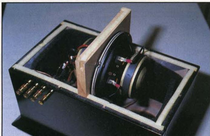
Il setto divisorio che ospita gli altoparlanti può essere sfilato dal mobile in modo da agevolare il montaggio ed il cablaggio.
